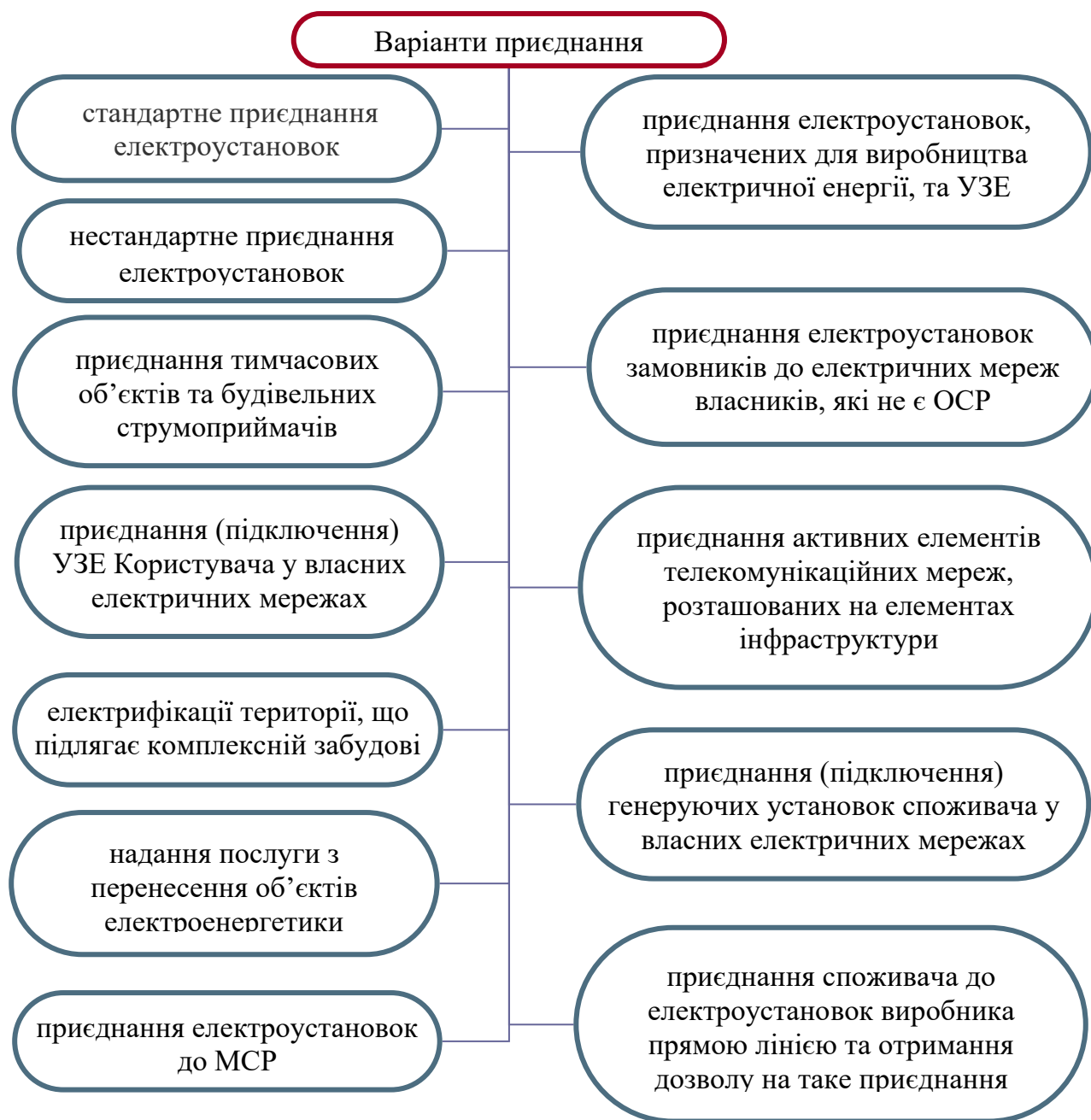
Рисунок 1.3 – Варіанти приєднання електроустановок до систем розподілу (побудовано за даними [90])
