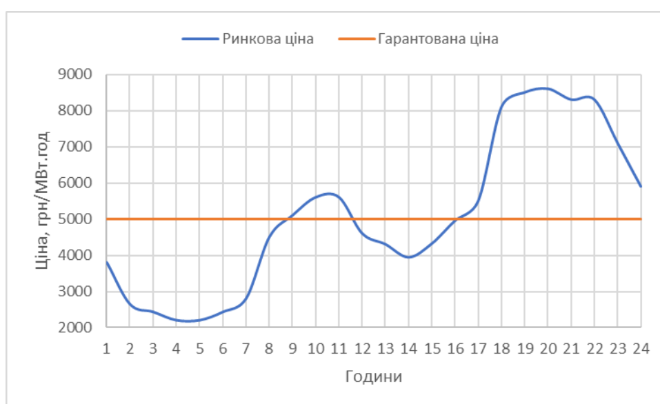
Рисунок 1.10 – Схема функціонування CfD
