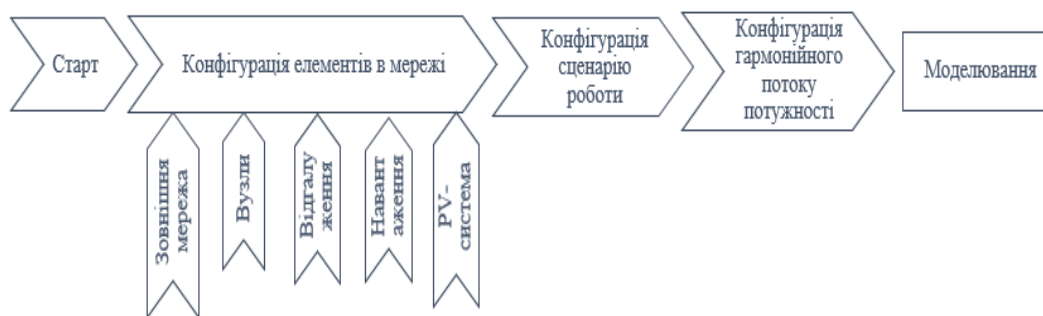
Рисунок 4.2 – Блок-схема підходу, застосованого в PowerFactory
