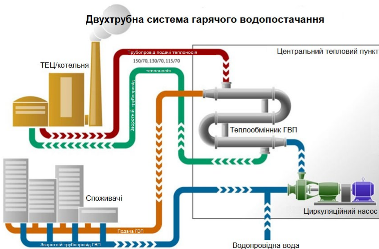
Рисунок 1.4 – Схема двухтрубной системы горячего водоснабжения.
