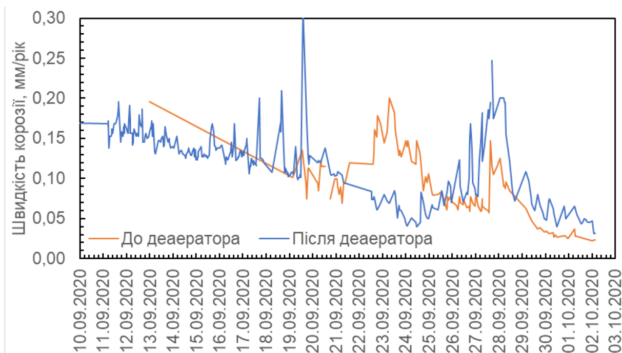
Рисунок 7.41 – Миттєві значення швидкості корозії на лінії підживлення.
