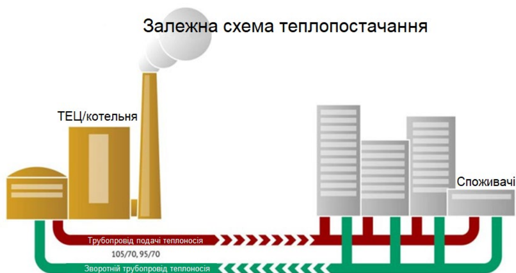
Рисунок 1.1 – Схема залежної системи теплопостачання.
