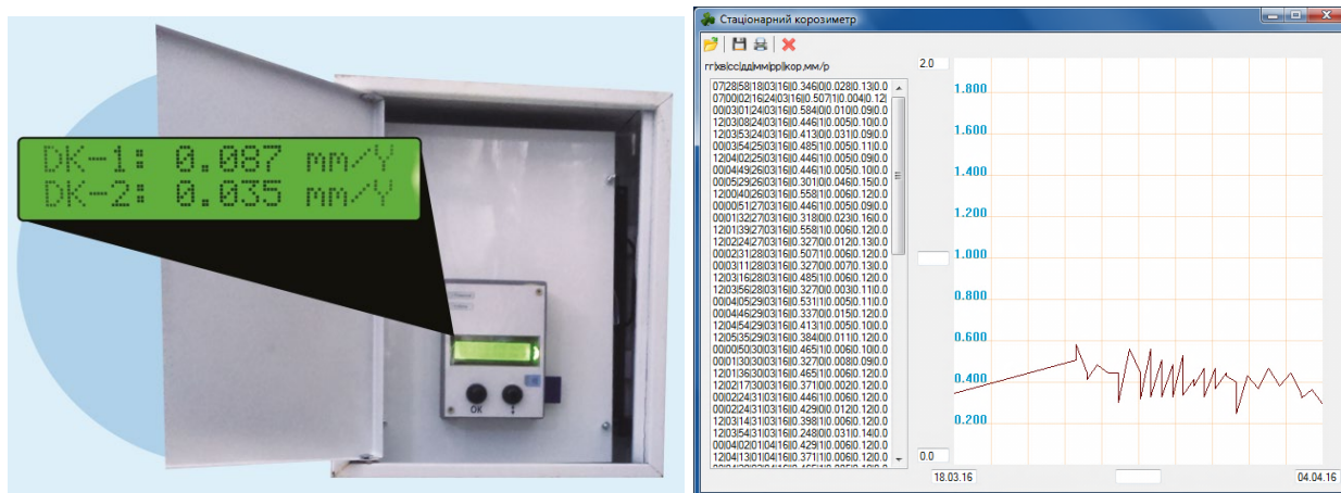
Рисунок 7.4 – Вигляд стаціонарного індикатора корозії ІК-4с (зліва та вікно програми для обробки даних (справа).
