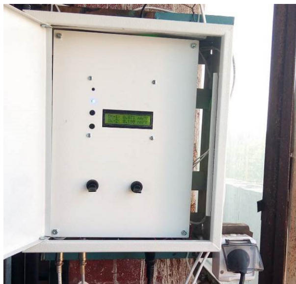
Рисунок 7.5 – Стационарний корозиметр «ІК-4с» з модулем дистанційної передачі.
