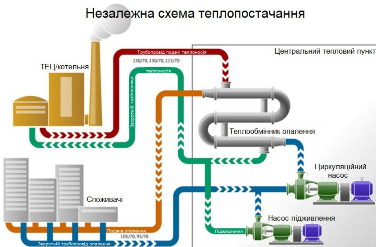
Рисунок 1.2 – Схема незалежної системи теплопостачання.
