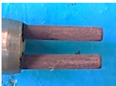
Рисунок 7.21 – Фото електродів датчика корозії, вилученого з трубопроводу підживлення 21.11.16 РК «Молодь»
