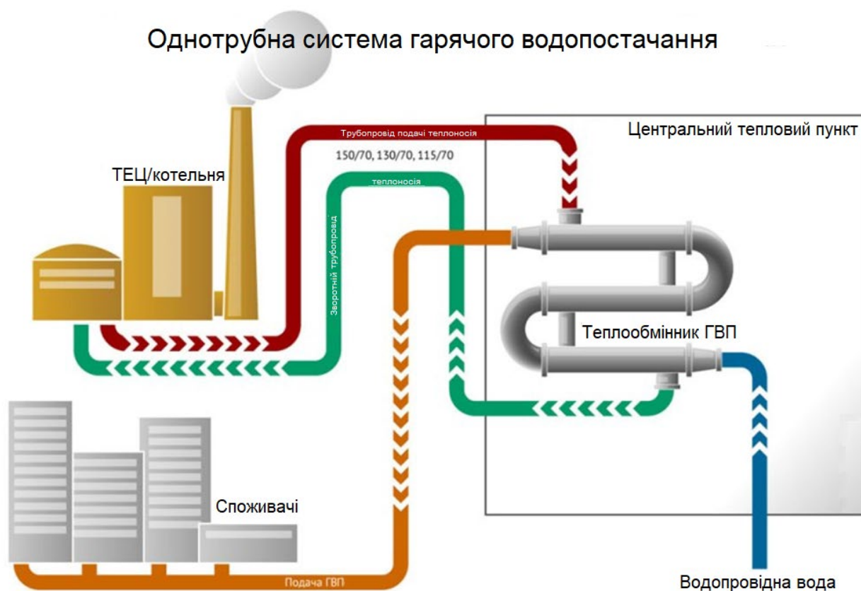
Рисунок 1.3 – Схема однотрубно-тепловодопостачання.
