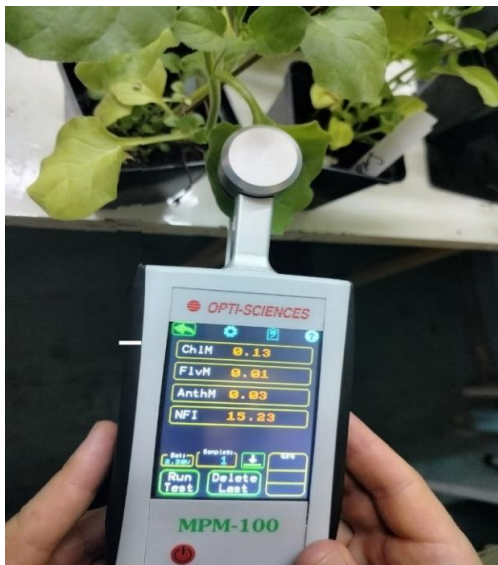
Рис 2.4 Вимірювання хлорофілів і антоціанів в рослинах Nicotiana benthamiana з використанням приладу Opti-Sciences MPM-100
