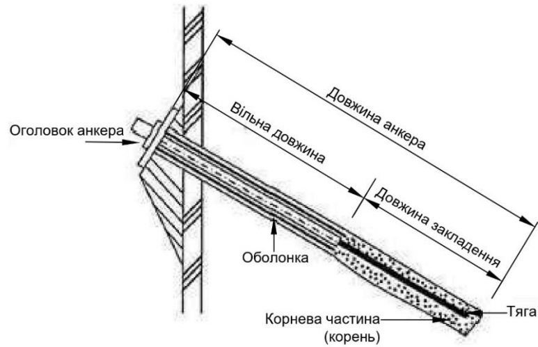
Рисунок 4.23 – Принципова конструкція ін'єкційного анкера
