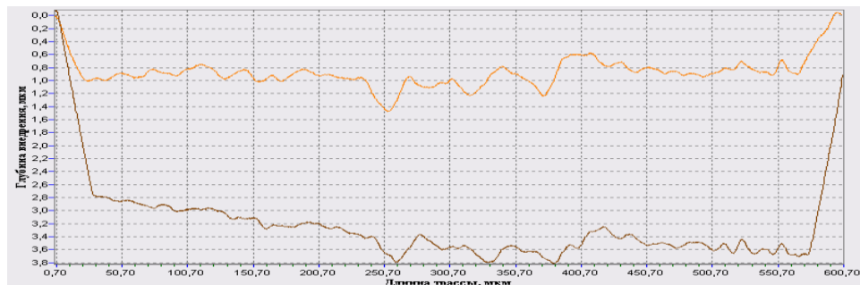
Рис. 4.3.5. Відновлений профіль зразка 1,5 \times 1,5h ( h_{\text{залиш}}=0,897 мкм, ER=71,5\% )
