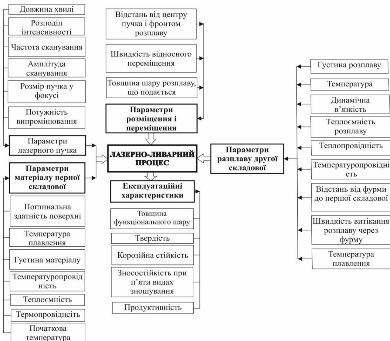
Рис. 2.1.2. Основні чинники і параметри лазерно-ливарного процесу виготовлення біметалів
