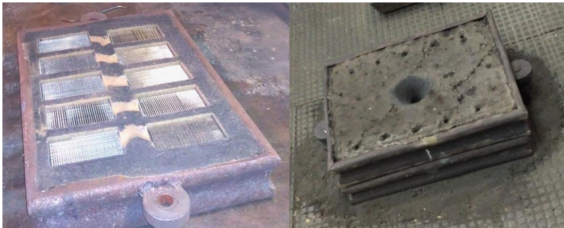
Рис. 3.2.2.3. Загальний вигляд ливарної форми: а - нижня напівформа(опока), ливарно форма в зібраному вигляді
