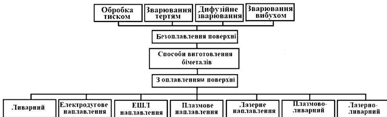
Рис.1.3.1. Найбільш поширені способи виготовлення біметалів
