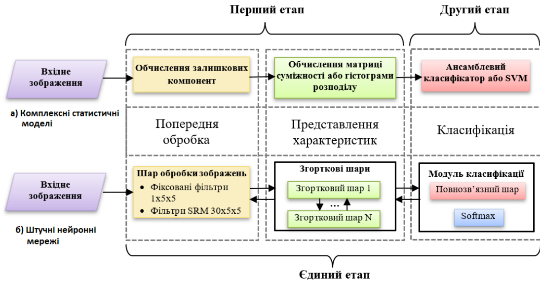
Рисунок 1.2 – Основні етапи обробки цифрових зображень в сучасних стегодетекторах, заснованих на використанні статистичних моделей ЦЗ (а) та згорткових нейронних мереж (б).
