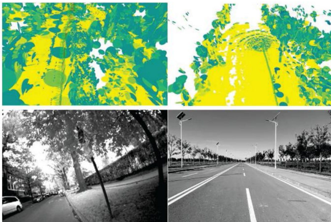
Рисунок 1.5 – Визначення безпечних та небезпечних зон пересування для БпНА за допомогою вбудованих сенсорів [7]
