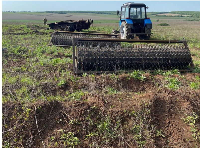
Рисунок 4.14 Тестова платформа – система розмінування з віддаленим керуванням у робочому режимі
