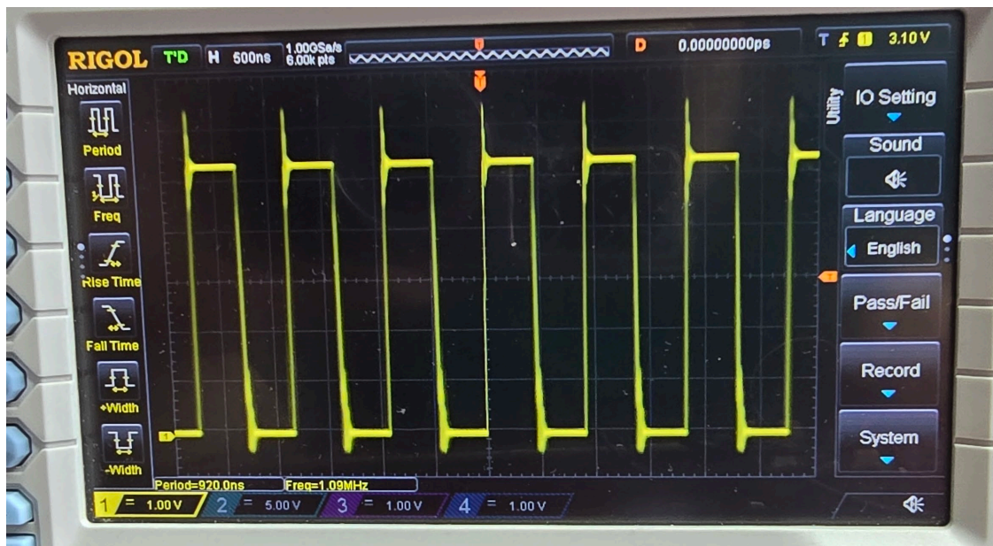
Рисунок 4.9 Осцилограма напруги на затворі GaN транзистора
