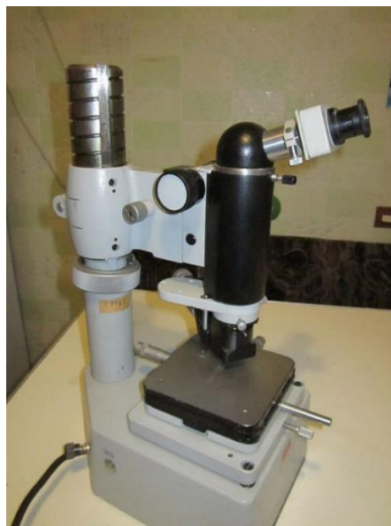
Рис. 2.20 Мікротвердомір ПМТ-3
