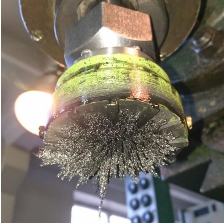
Рис. 2.8 Зображення магнітно-абразивної головки змонтованої на верстатному устаткуванні
