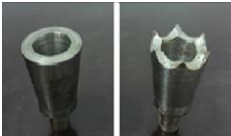
Рис. 1.9 Зображення конусного (зліва) та фігурного (праворуч) полюсних наконечників
