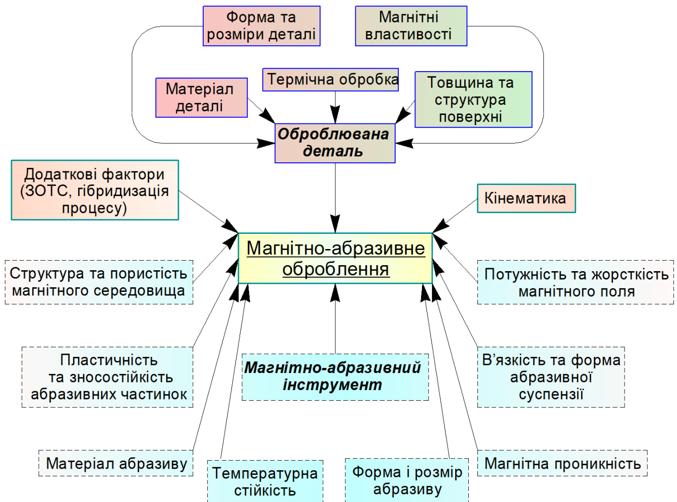
Рис. 1.4. Фактори, що формують процес MAO та вихідну якість поверхні
