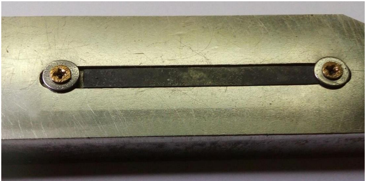
Рис. 2.17 Пристосування для фіксації дослідних зразків для проведення МАО [45, 46]
