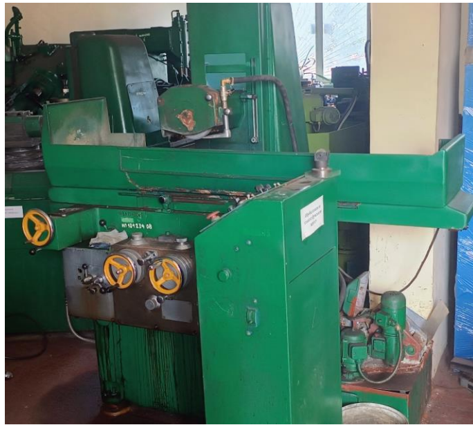
Рис. 2.4 Універсальний плоскошліфувальний верстат мод. 3Г71М
