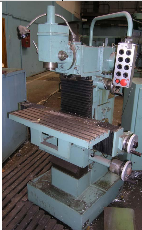
Рис. 2.5 Універсальний вертикально-фрезерний верстат мод. 6Б75ВФ1
