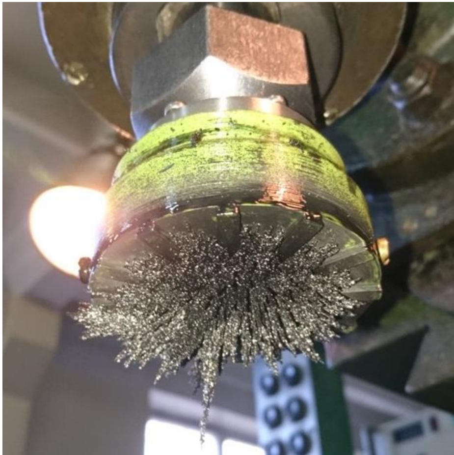
Рис. 2.8 Зображення магнітно-абразивної головки змонтованої на верстатному устаткуванні
