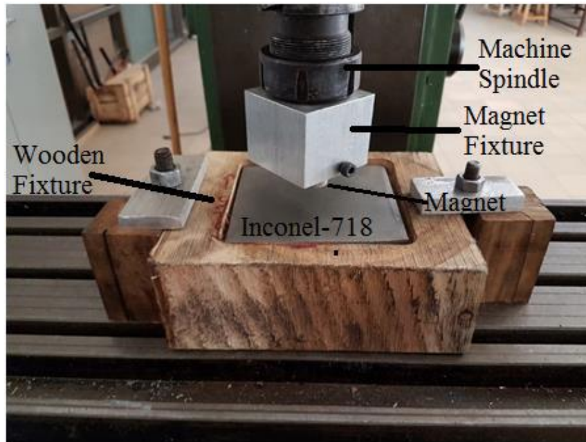
Рис. 1.21 Зображення експериментальної установки із дерев'яним зажимом
