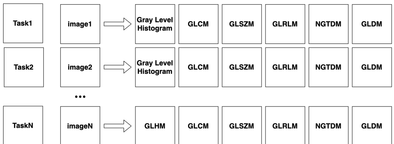
Рис. 3.14.Схема паралелізації за завдання-орієнтованим підходом
