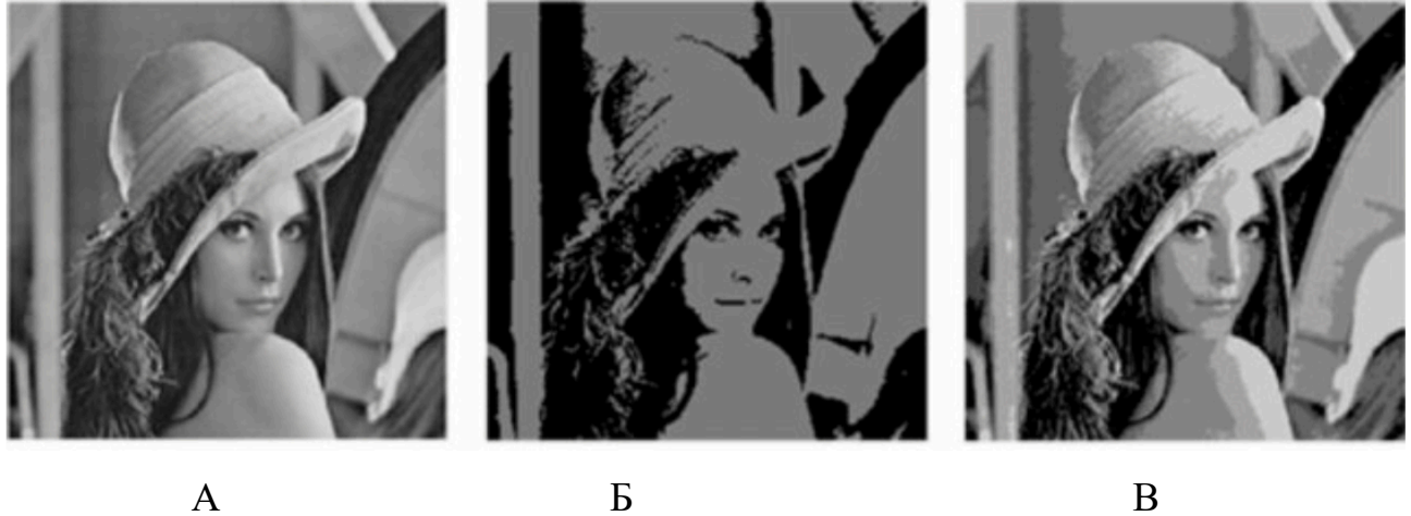
Рис. 1.1. Приклад застосування методів порогової сегментації: А – оригінальне зображення, Б – застосування бінарного порогу (Bi-Level), В – застосування багаторівневого порогу (Multi-level)
