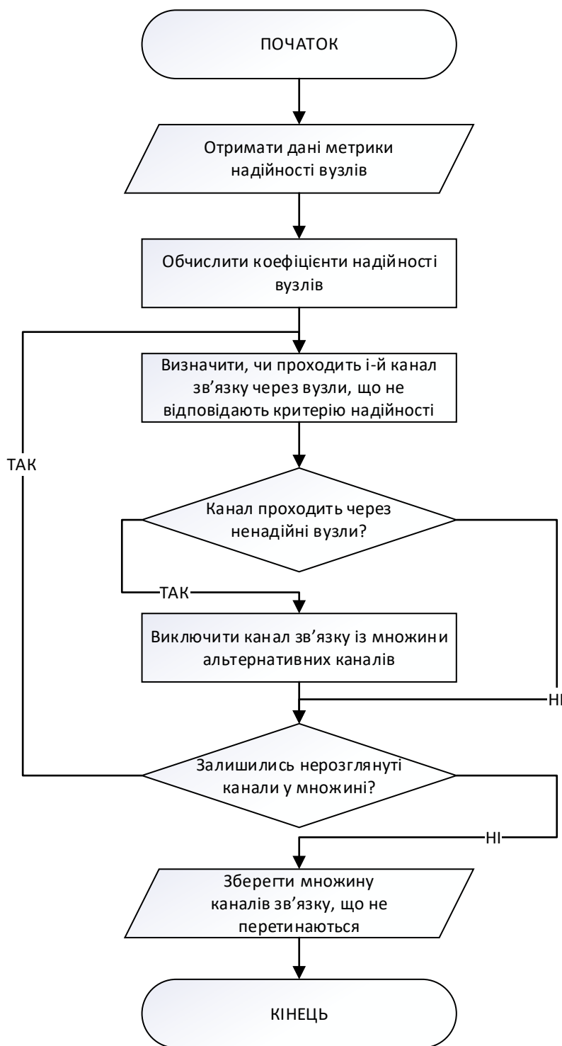
Рис. 3.11. Алгоритму відбору каналів зв'язку по критерію надійності вузлів
