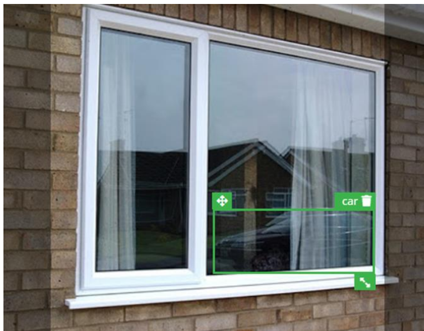
Рисунок 4.1 – Приклад хибного розпізнавання цільового об'єкту
