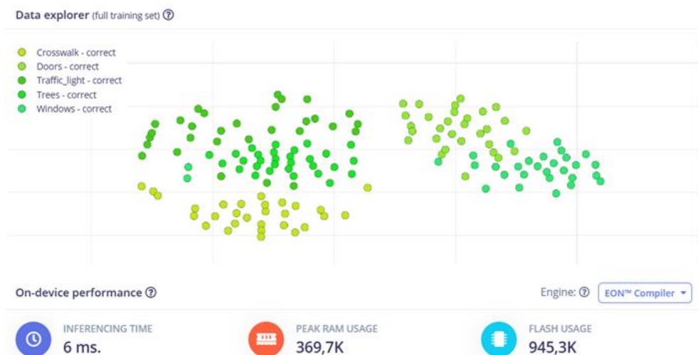
Рисунок 4.21 - Візуальний розподіл результатів розпізнавання моделі MobileNetV2 160x160 0.5 на базі плати Raspberry Pi 5
