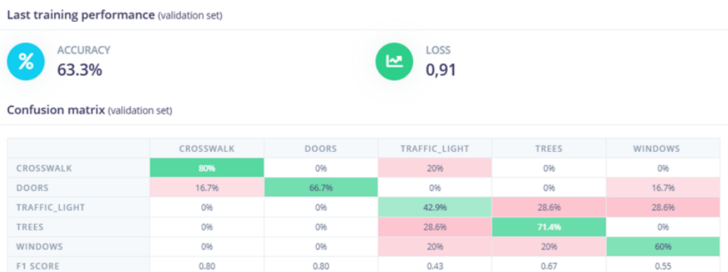
Рисунок 4.8 – Результати точності розпізнавання мережі MobileNetV1 96x96 0.2 для ESP32-S3-EYE
