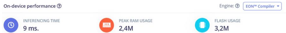
Рисунок 2.27 - Теоретичний час та необхідні ресурси для мережі MobileNetV2 160x160 0.5 на базі NVIDIA Jetson Nano
