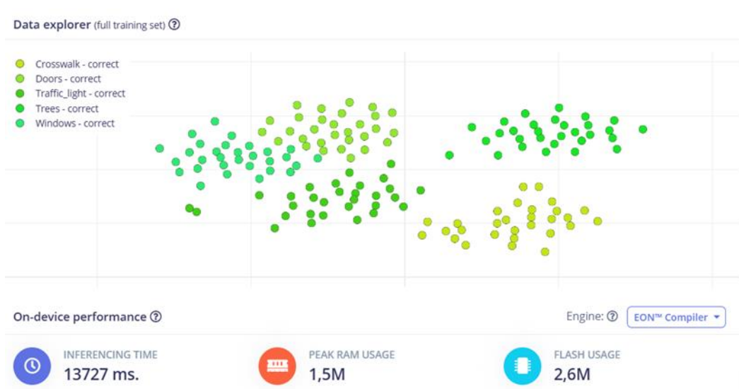
Рисунок 4.16 - Візуальний розподіл результатів розпізнавання мережею MobileNetV2 160x160 1 для ESP32-S3-EYE
