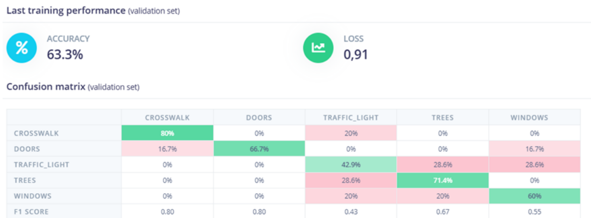
Рисунок 4.17 - Точність розпізнавання мережі MobileNetV1 96x96 0.2 на базі плати Raspberry Pi 5.
