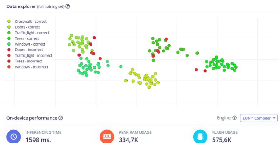
Рисунок 4.11 – Графічне представлення результатів розпізнавання мережі MobileNetV2 96x96 0.35 для ESP32-S3-EYE
