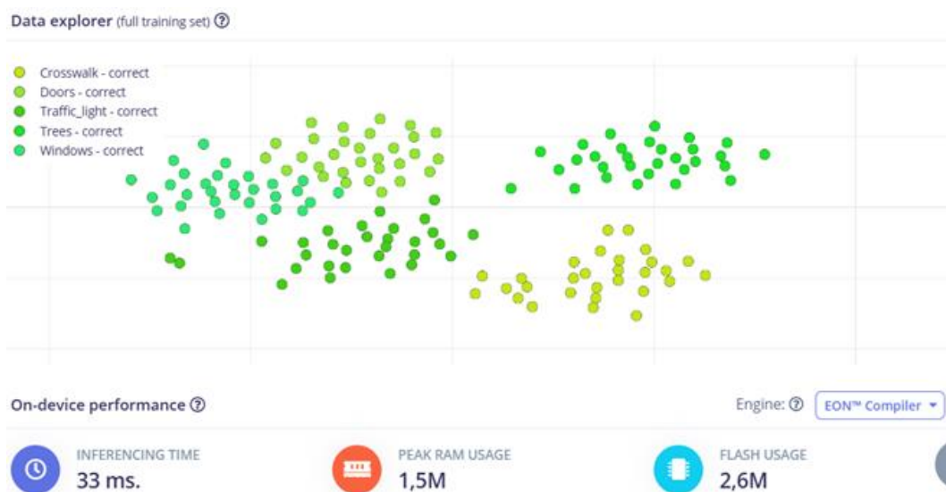
Рисунок 4.22 - Візуальний розподіл результатів розпізнавання моделі MobileNetV2 160x160 1 на базі плати Raspberry Pi 5
