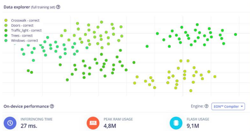
Рисунок 4.28 - Візуальний розподіл результатів розпізнавання мережею MobileNetV2 160x160 1 та прогнозований час розпізнавання
