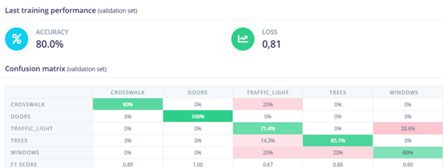
Рисунок 4.23 - Точність розпізнавання мережі MobileNetV1 96x96 0.2 на базі плати NVIDIA Jetson Nano.
