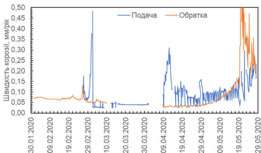
Рисунок 16 – Миттєва швидкість корозії в тепловій мережі, визначена корозиметром ІК-4с в ході випробувань технології реагентної водопідготовки.
