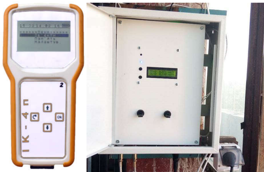
Рисунок 14 – Портативний корозиметр ІК-4п (зліва) та стаціонарний корозиметр ІК-4с (справа).
