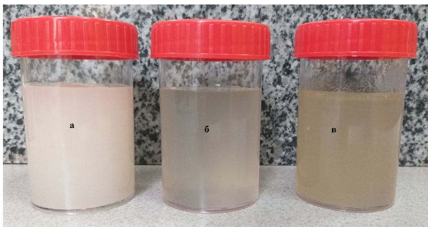
Рисунок 3.20 – Фотографії флаконів із очеретяною НЦ: а – після гідролізу ООЦ без УЗ обробки; б – теж саме після УЗ обробки; в – зразок б після 3 місяців зберігання
