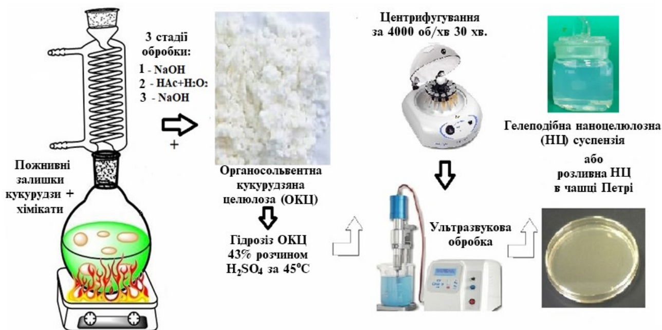
Рисунок 3.1 – Загальна схема процесу одержання з ПРК целюлози і НЦ
