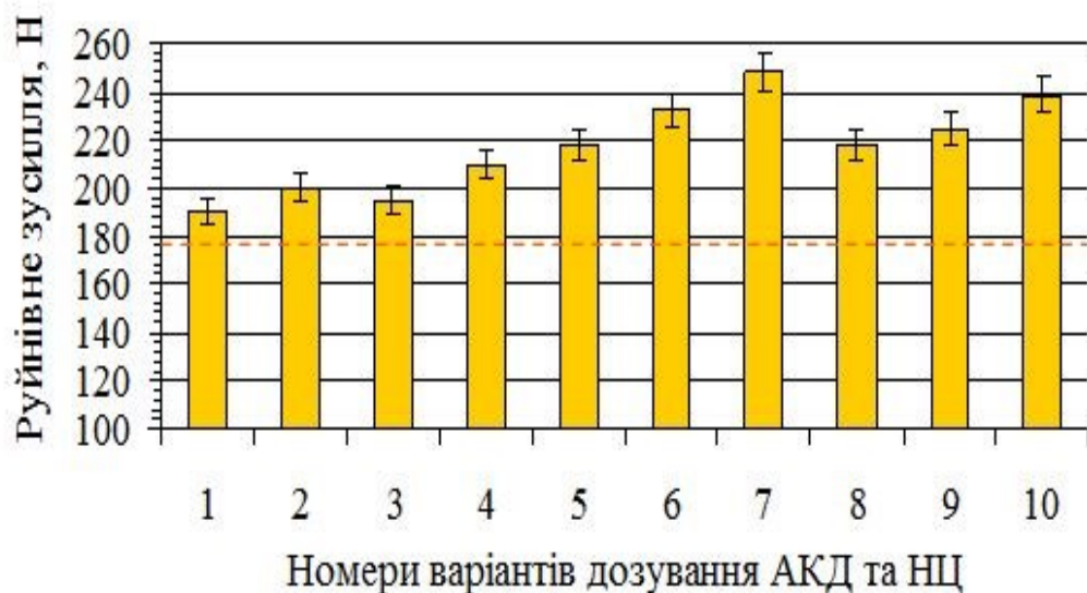
Рис. 4.21 – Руйнівне зусилля при стисненні кільця зразків картону досліджених варіантів (табл. 4.7); пунктиром показано вимоги стандарту
