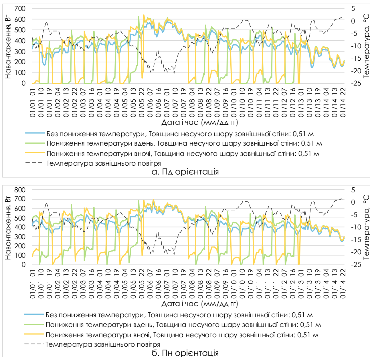
Рисунок 4.15 – Навантаження на систему опалення з пониженням температури внутрішнього повітря вночі: а. Південна орієнтація зовнішніх стін; б. Північна орієнтація зовнішніх стін. (внутрішні стіни: 0,255 м)
