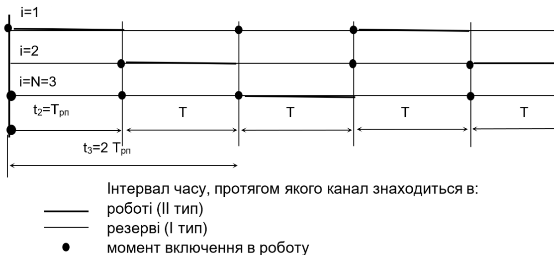
Рисунок 3.14 – Діаграма функціонування системи з трьох каналів за наявності планових АВР і додаткових випробувань резервного каналу
