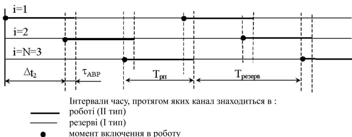
Рисунок 3.12 – Діаграма функціонування системи з трьох паралельних каналів за наявності АВР
