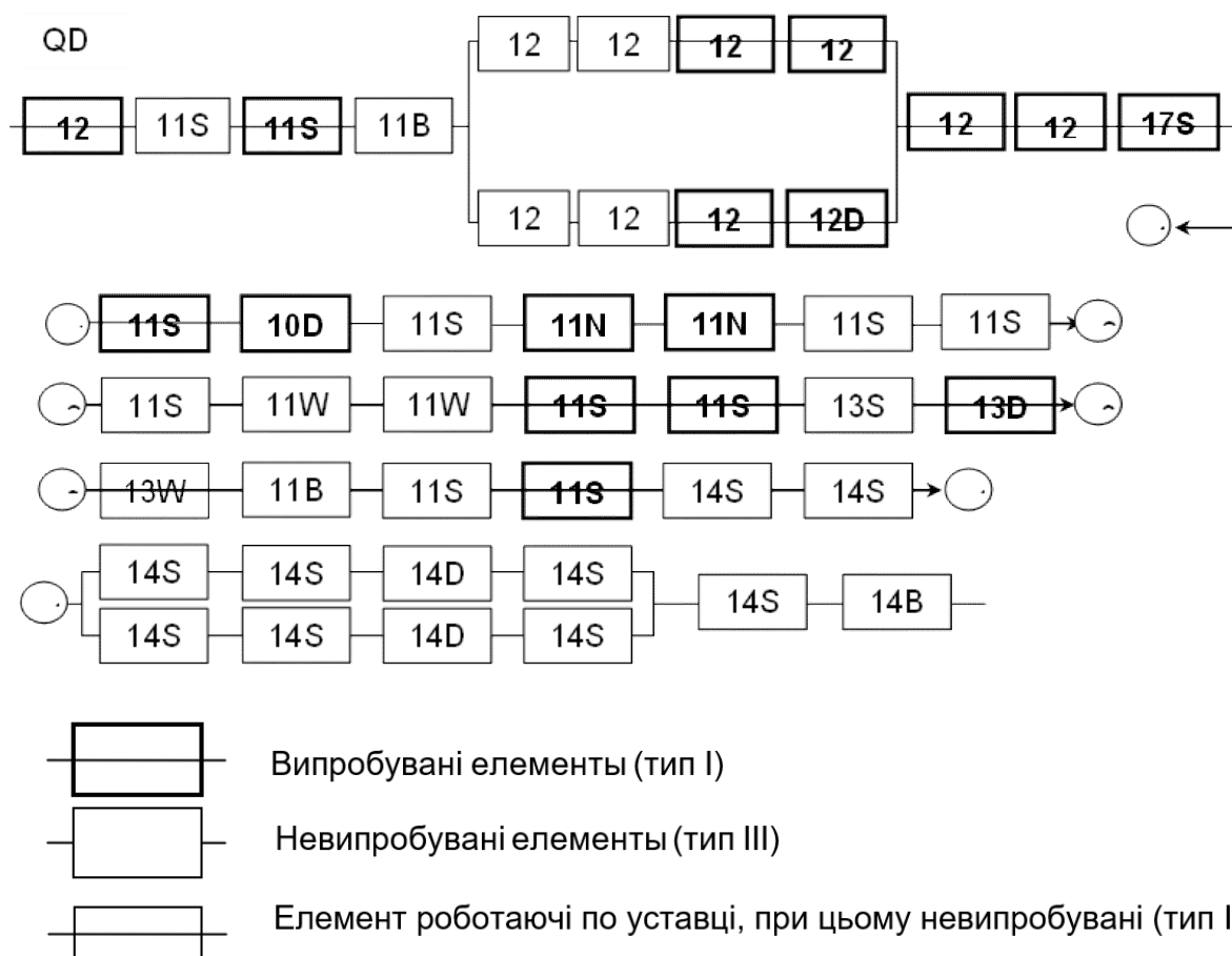
Рисунок В.28 – Логічна схема маслосистеми РДЕС для різних компоновань
