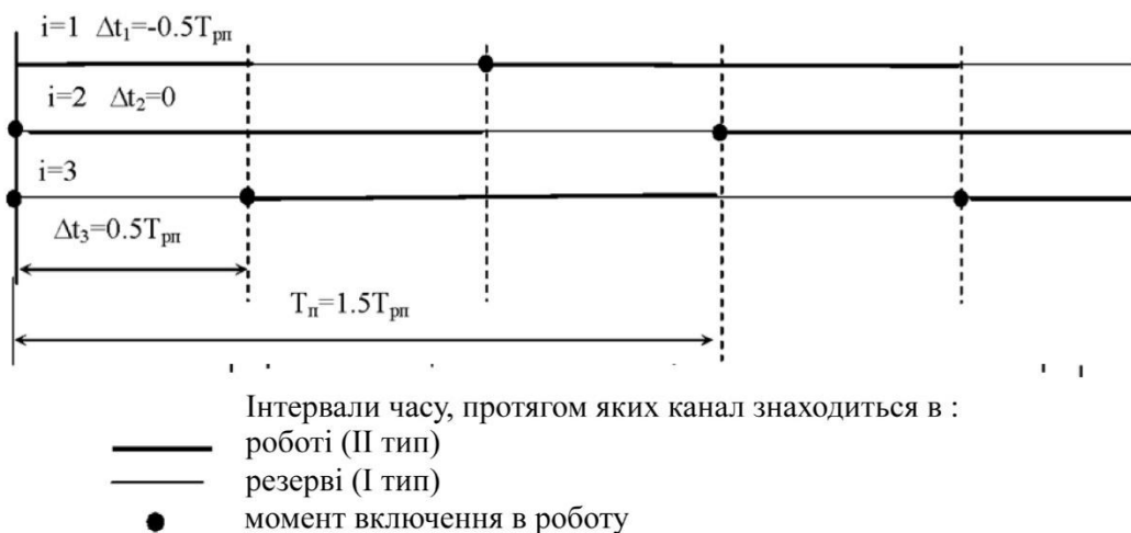
Рисунок 3.17 – Діаграма функціонування системи з трьох каналів за наявності планових АВР і одночасній роботі двох каналів [55]
