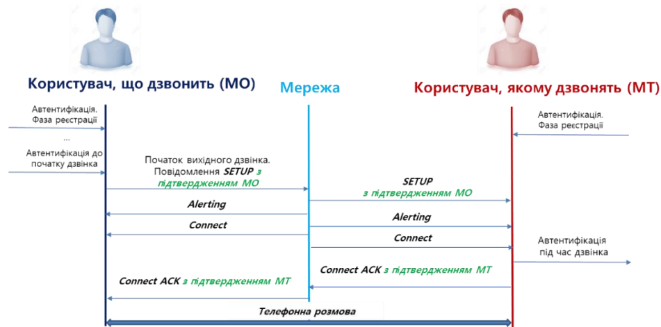
Рис. 16. Модифікований протокол обміну повідомленнями під час проходження голосового дзвінка через мережу
