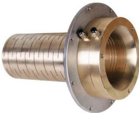
Рисунок 1.19 – Конструкція калібрувального пристрою з трьома зонами розрідження та інтенсифікацією охолодження вхідної частини калібрувальної гільзи [53]
