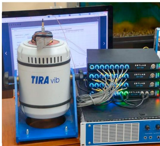
Рисунок 2.17 – Фото та структурна схема експериментального електродинамічного випробувального стенду TIRAvib (розроблено автором, розкрито в праці [63])
