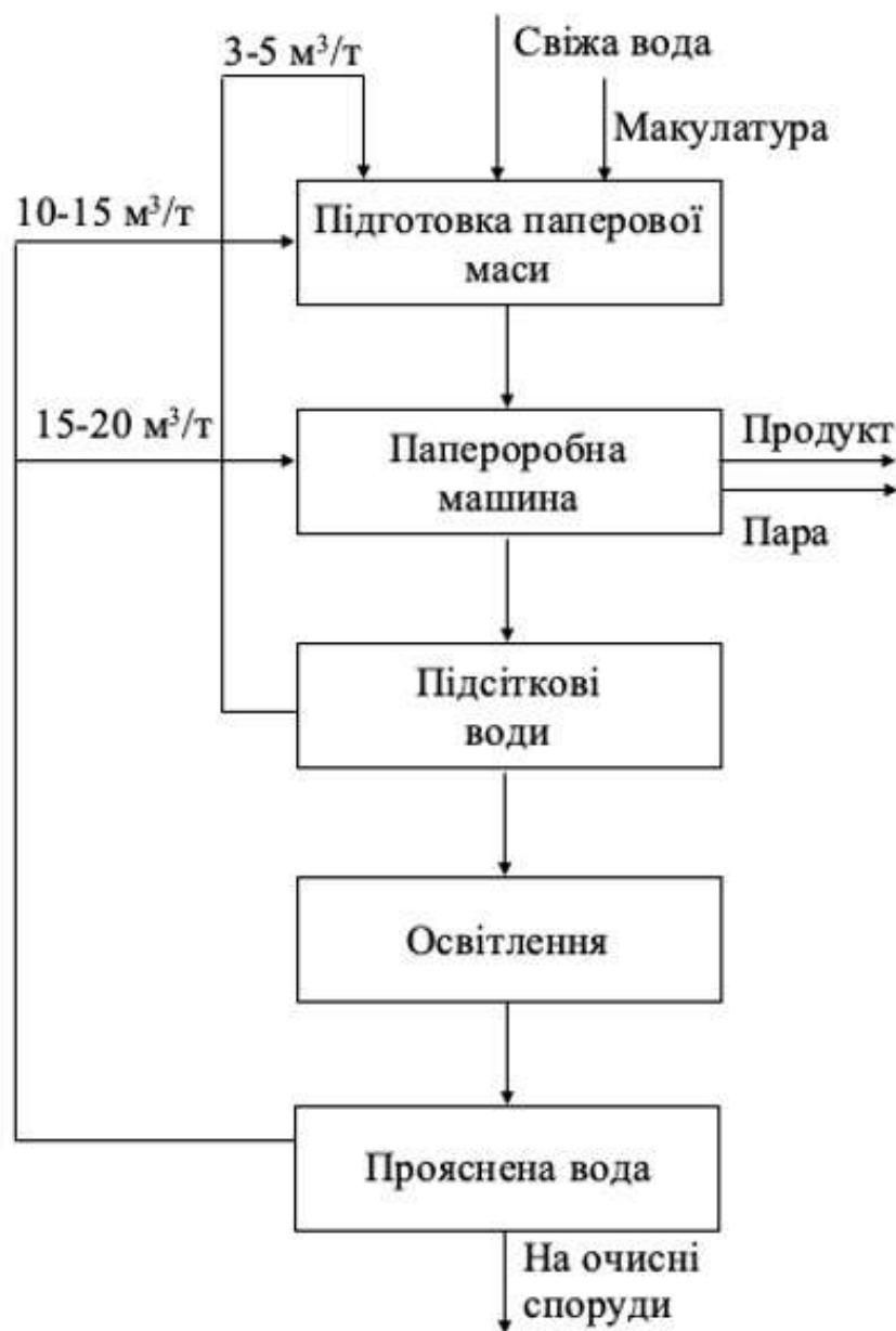
Рисунок 1.5 – Узагальнена схема використання обігових вод на паперових фабриках.
