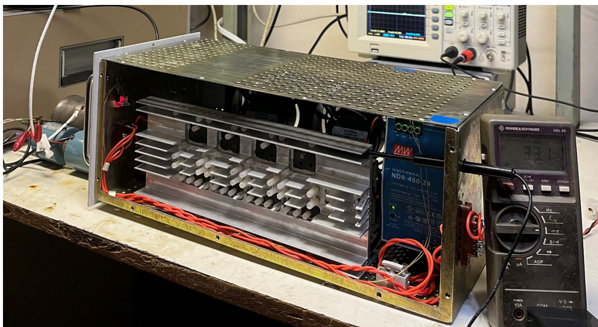
Рисунок 2.12. Зовнішній вигляд блоку підсилювача в зборі з радіатором та корпусом.
