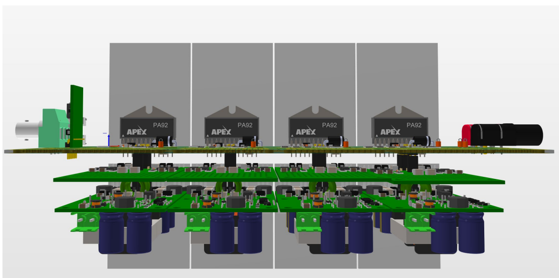
Рисунок 2.9. Комп'ютерна модель багаторівневої конструкції підсилювача.
