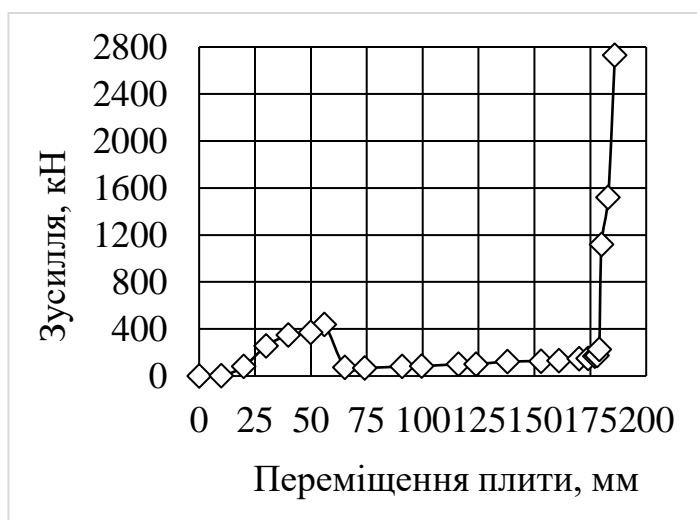
Рисунок 4.4. Залежність зусилля обтиску та осаджування від переміщення плити
