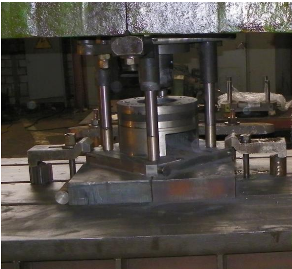
Рис. 5.29. Фото штампа для гарячого витягування з потоншенням стінки встановленого на пресі ПА198
