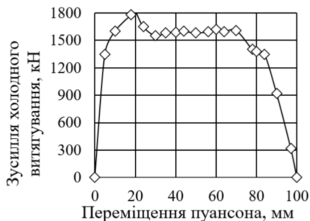
Рисунок 5.32. Залежність зусилля холодного витягування з потоншенням від переміщення пуансона
