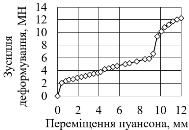
Рисунок 5.4. Залежність зусилля деформування від переміщення пуансона
