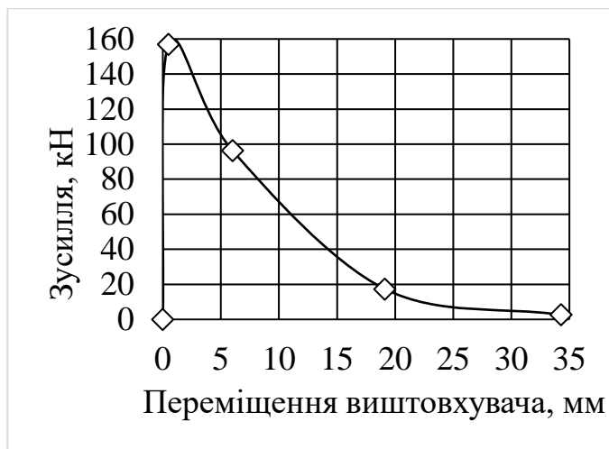
Рисунок 4.5. Залежність зусилля виштовхування напівфабрикату від переміщення виштовхувача
