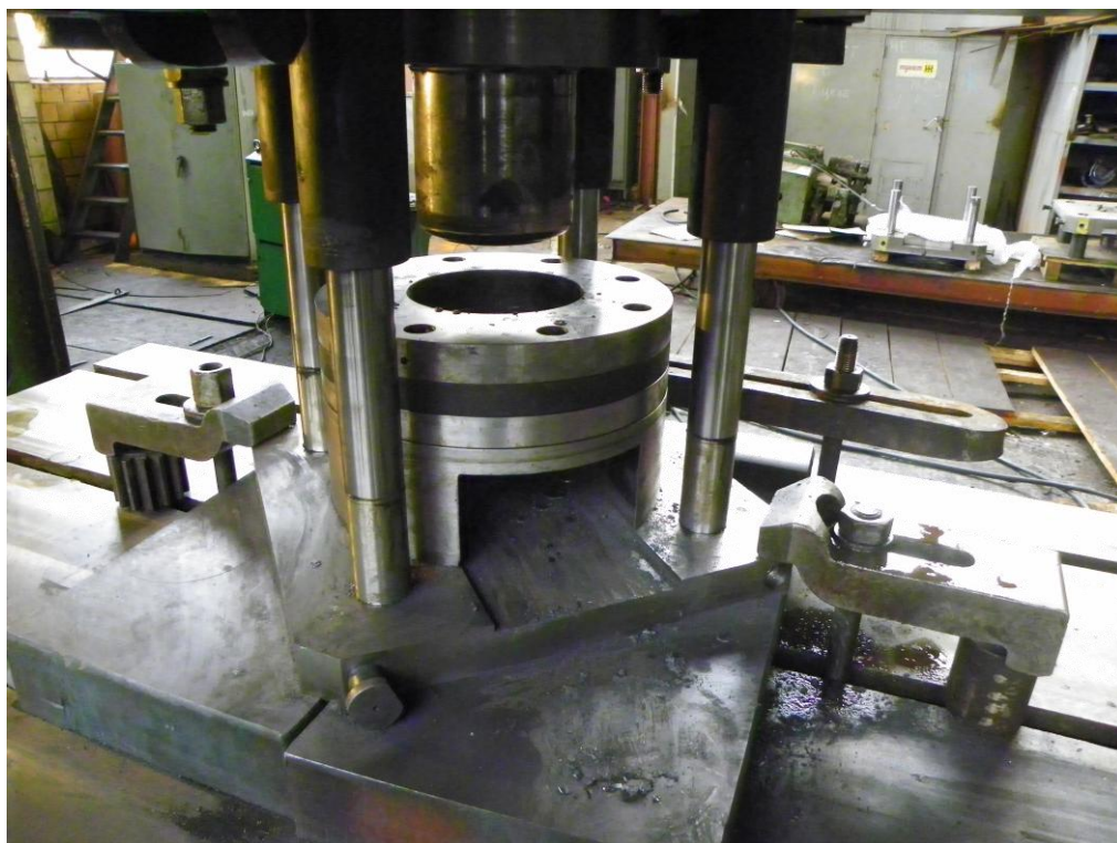
Рис. 5.40. Фото штампа для холодного витягування з потоншенням стінки встановленого на пресі ПА198
