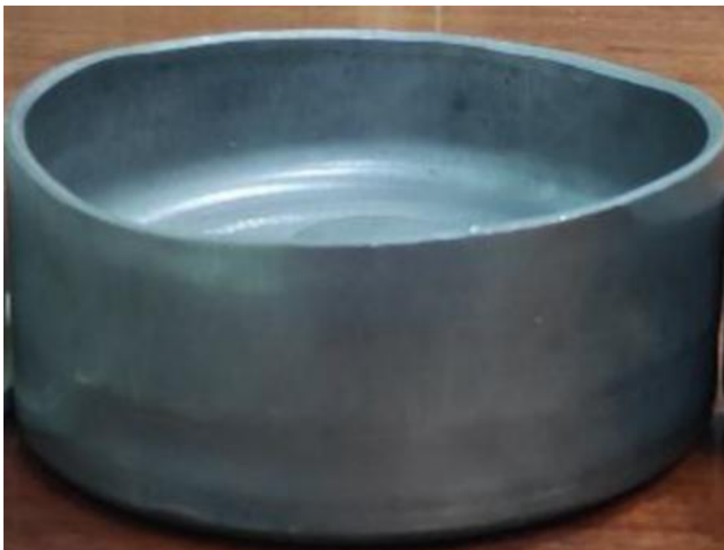
Рис. 5.41. Фото форми отриманого напівфабрикату в розрізі після проведення натурального експерименту
