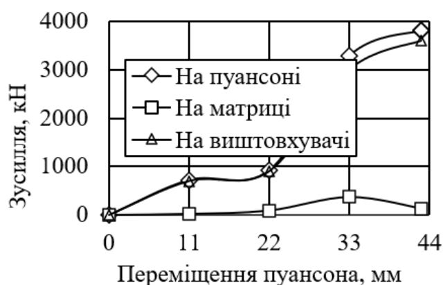
Рисунок 2.20. Залежності зусиль видавлювання виробу із попередньо осаджуваного напівфабрикату квадратної форми на пуансоні, виштовхувачі і матриці від переміщення пуансона
