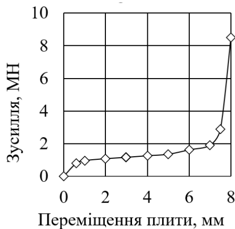
Рис. 6.27. Залежність зусилля гарячого осаджування від переміщення плити
