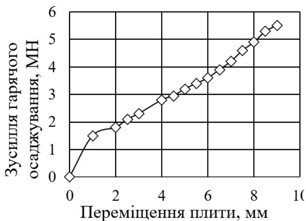
Рисунок 5.43. Залежність зусилля гарячого осаджування фланця від переміщення плити
