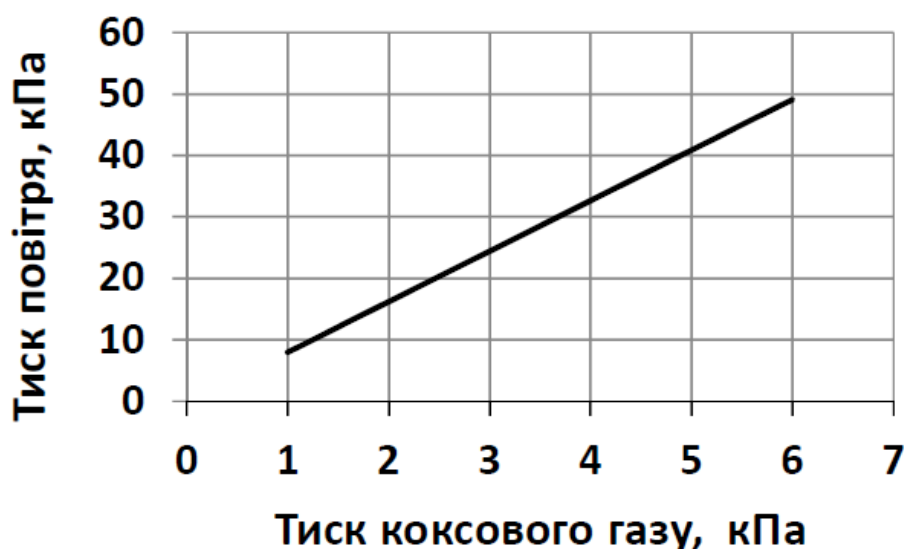
Рисунок 1.6 – Регульовальна характеристика дослідного пальника [31].
