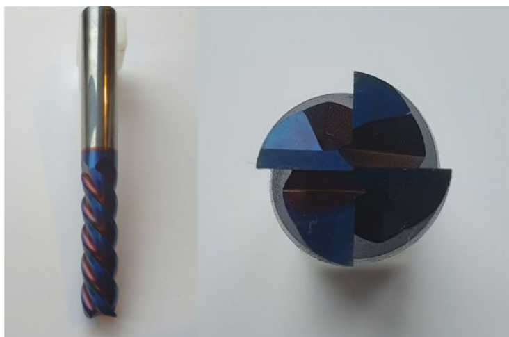
Рисунок 3.21 – Кінцева фреза, вигляд: а) зліва б) з торця
