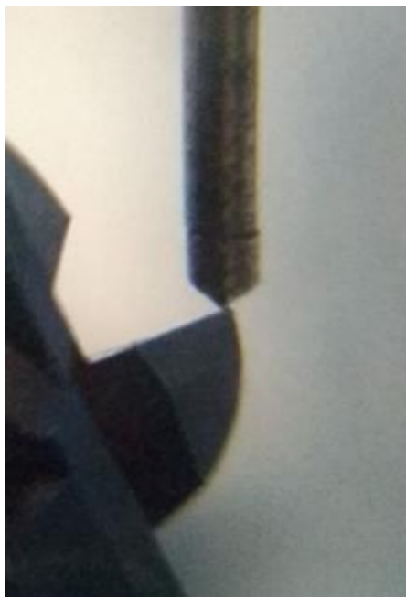
Рисунок 3.23 – Вимірювання заднього кута ( \alpha ) кінцевої фрези
