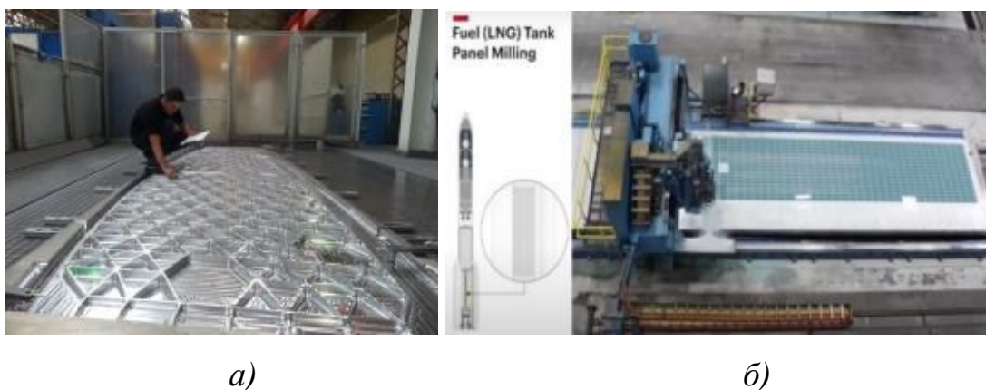
Рисунок 1.5 – Нервюра крила літака A330neo а) [8] та панель паливного баку ракети Вулкан б) [9]
