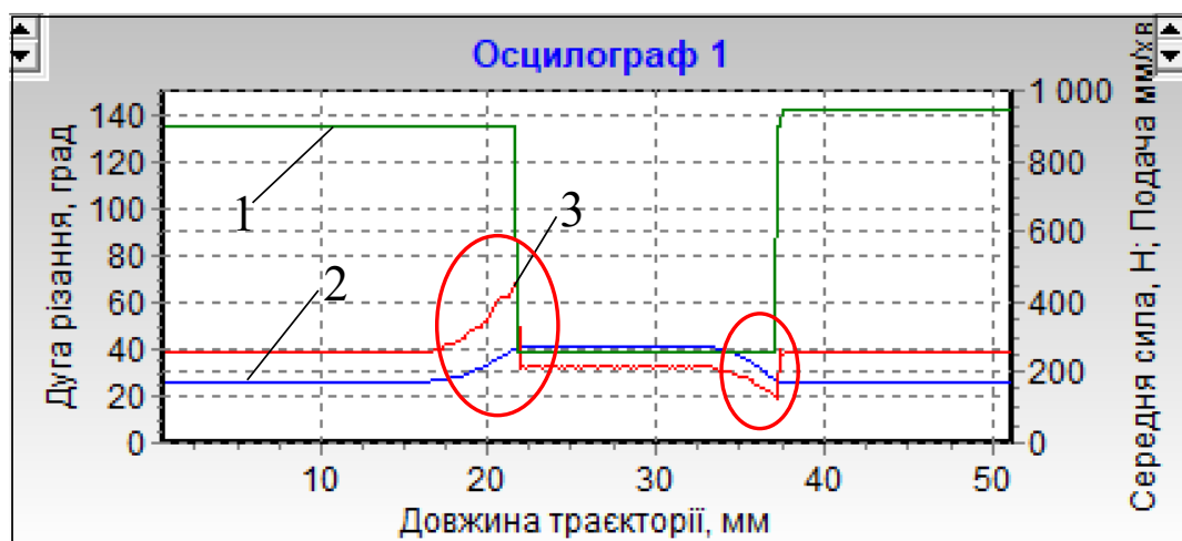
Рисунок 3.11 – Результати моделювання процесу фрезерування з контролем подачі за допомогою технології iMachining [21]
