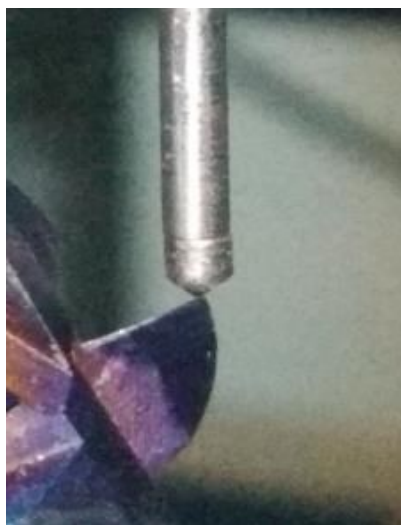
Рисунок 3.22 – Вимірювання переднього кута ( \gamma ) кінцевої фрези
