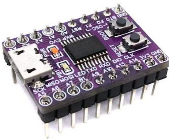
Рисунок 4.27 — Плата контролера STM320F030 та його характеристики
