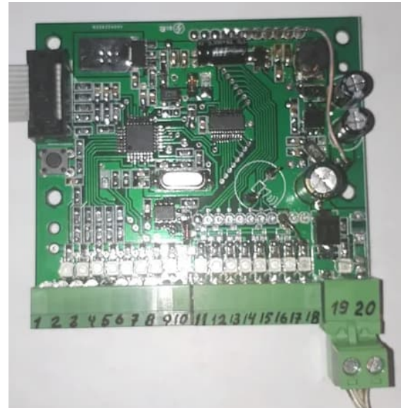
Рис. 7.29. Печатна плата експериментального контролера-логічного автомата
