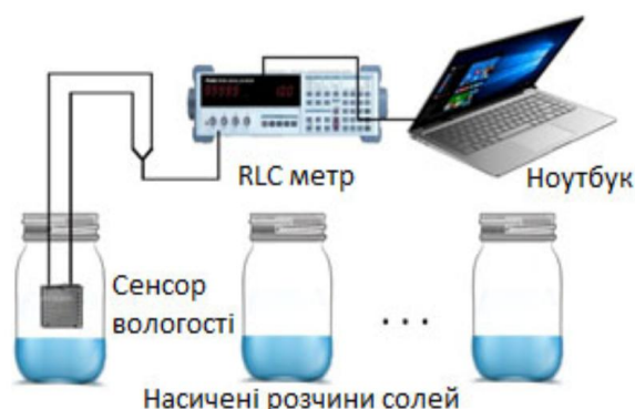
Рисунок 2.7 – Структура вимірювального стенду для дослідження сенсорів вологості
