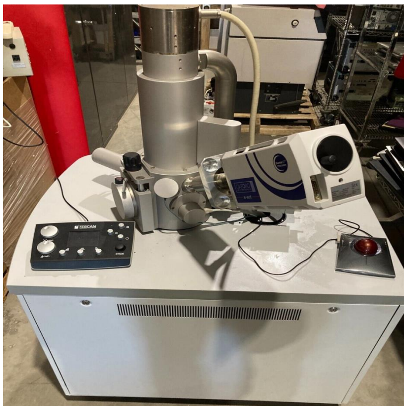
Рисунок 2.3 – Зовнішній вигляд скануючого електронного мікроскопу TESCAN VEGA 3
