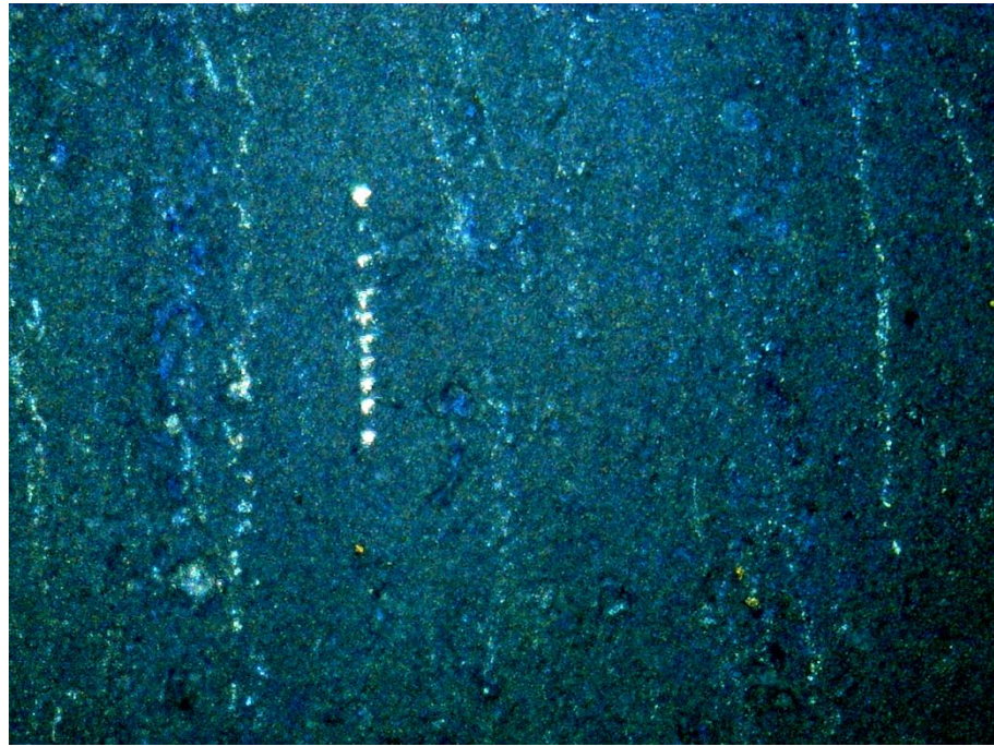
Рисунок 2.11 – Фотозображення поверхні нікелевого покриття із індентуваннями
