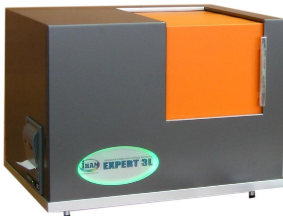
Рисунок 2.4 – Зовнішній вигляд енергодисперсійного рентгенофлуоресцентного експрес-аналізатору EXPERT 3L
