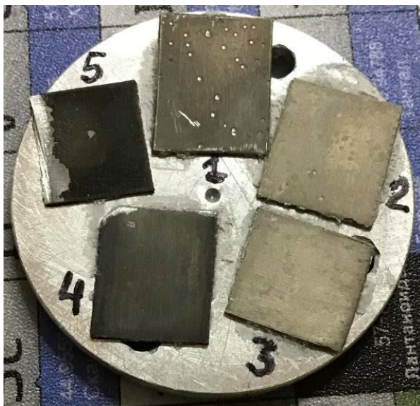
Рисунок 2.10 – Фотозображення розміщених для випробувань зразків сталеві стрічки із електроосадженими нікелевими покриттями
