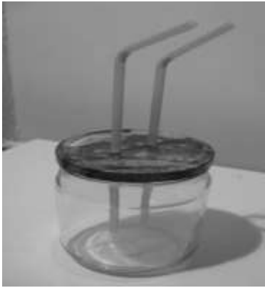
Рисунок 2.3 – Ємність для сприйняття ретроназального аромату (модифікація ольфактометру)
