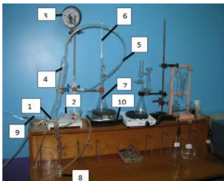
Рисунок 2.5 – Лабораторна установка для уловлювання АР
