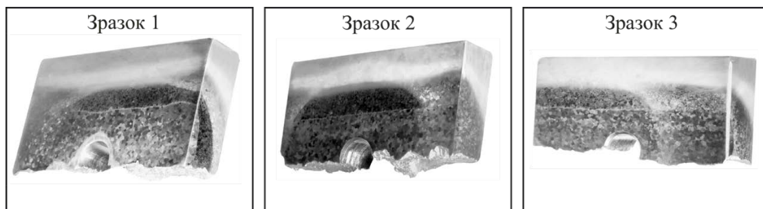
Рисунок 3.14 - Фотографії шліфів фрагментів зразків першої групи
