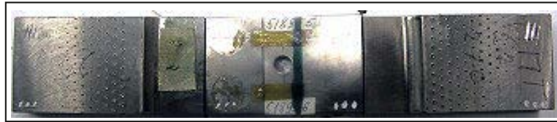
Рисунок 2.5 - Зовнішній вигляд зразка з відновленою поверхнею, що пройшов втомні випробування
