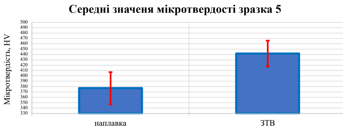
Рисунок 3.22 - Розподіл мікротвердості зон наплавлення та ЗТВ зразка 5 після локальної термічної обробки
