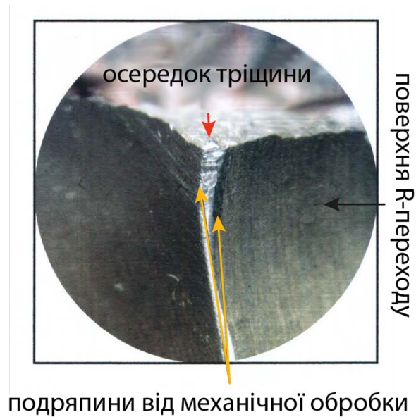
Рисунок 1.22 - Риски на поверхні округлення кромки штоку №3 в осередку тріщини.
