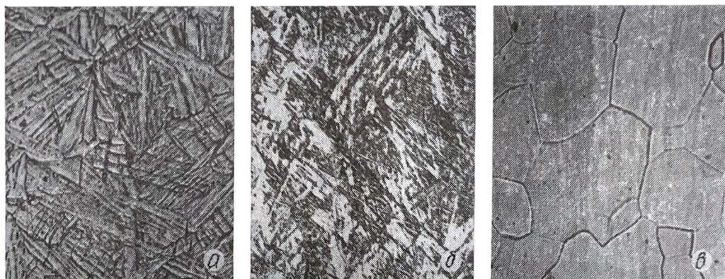
Рисунок 1.16 – Мікроструктура \alpha -сплаву VT5 (а), (\alpha+\beta) -сплаву VT14 (б) та псевдо \beta -сплаву VT15 (в), [9]
