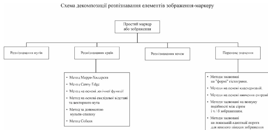
Рисунок Б.4 – Схема декомпозиції процесу розпізнавання маркеру [7]
