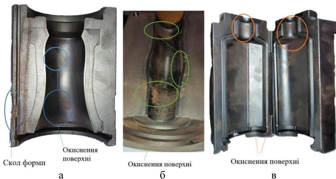
Рисунок 1.10 – Дефекти, що спричинили вихід з ладу чорнової (а, б) та чистової (в) чавунних форм
