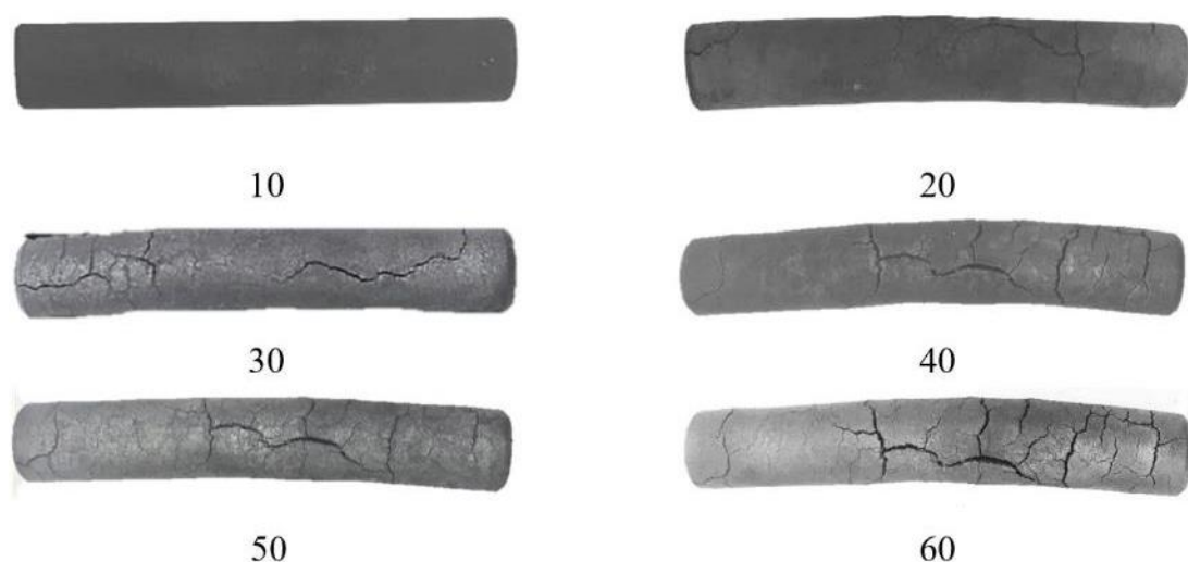
Рисунок 3.8 – Зовнішній вигляд зразка із чавуну 310СМ після циклічних випробувань від 10 циклів до 60 циклів
