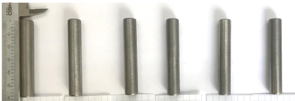
Рисунок 2.10 – Зовнішній вигляд підготовлених зразків перед дослідженням термостійкості та ростостійкості
