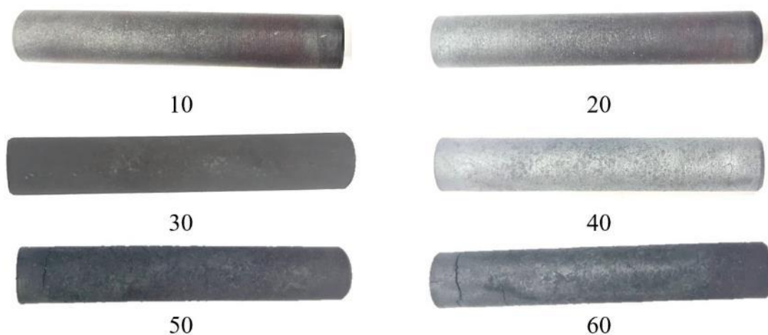
Рисунок 3.10 – Зовнішній вигляд зразка із чавуну 350СМХАН після циклічних випробувань від 10 циклів до 60 циклів
