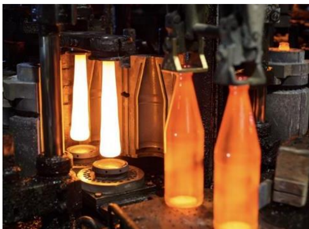
Рисунок 1.7 – Видування склотари в промислових умовах [14]
