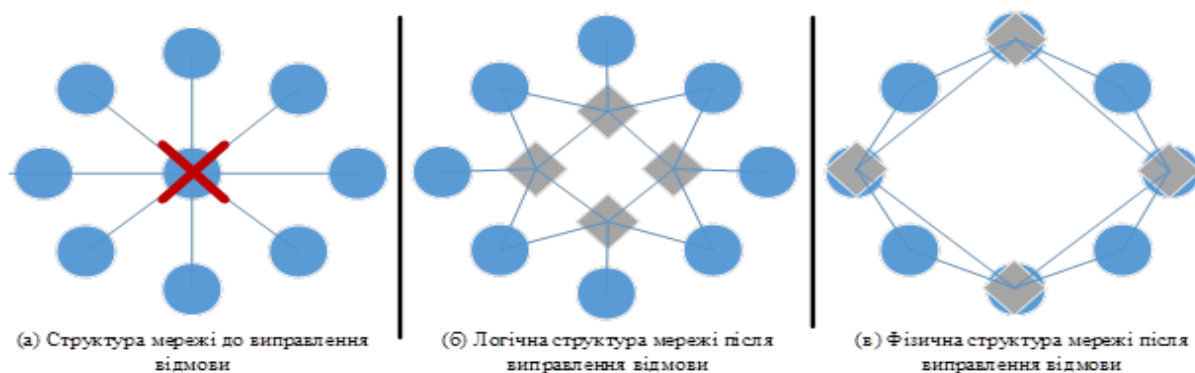
Рис. 1.3. Принцип роботи алгоритму Forgiving Graph
