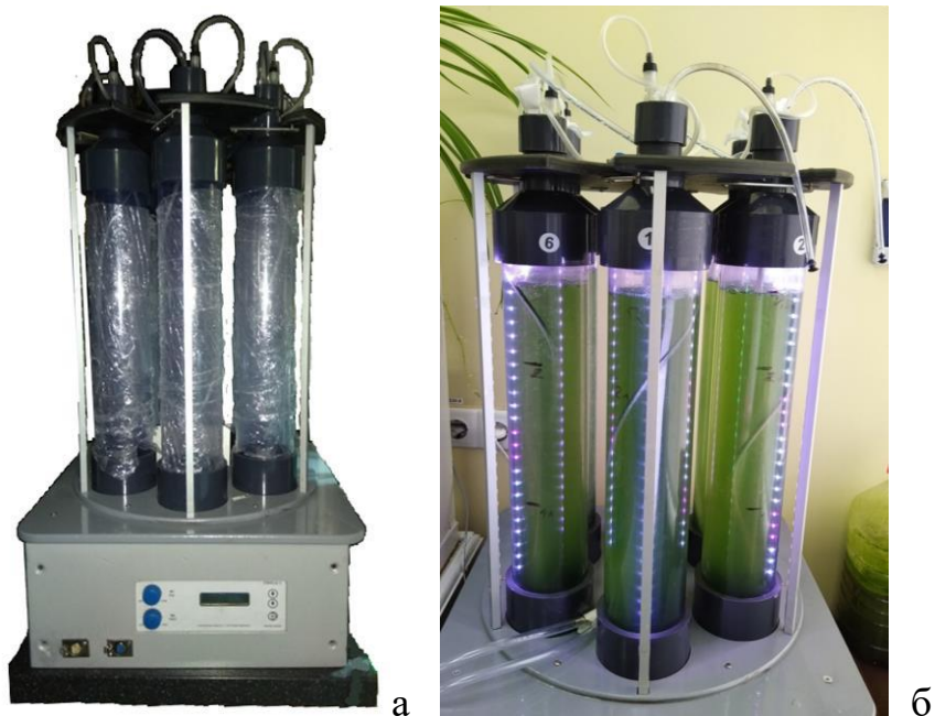
Рисунок 2.1. а) загальний вигляд дослідної установки PBRCА-1, б) установка під час роботи.
