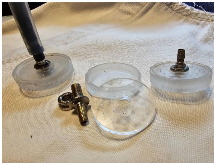
Рисунок 3.1. Зовнішній вигляд дифузорів з різною кількістю отворів.
