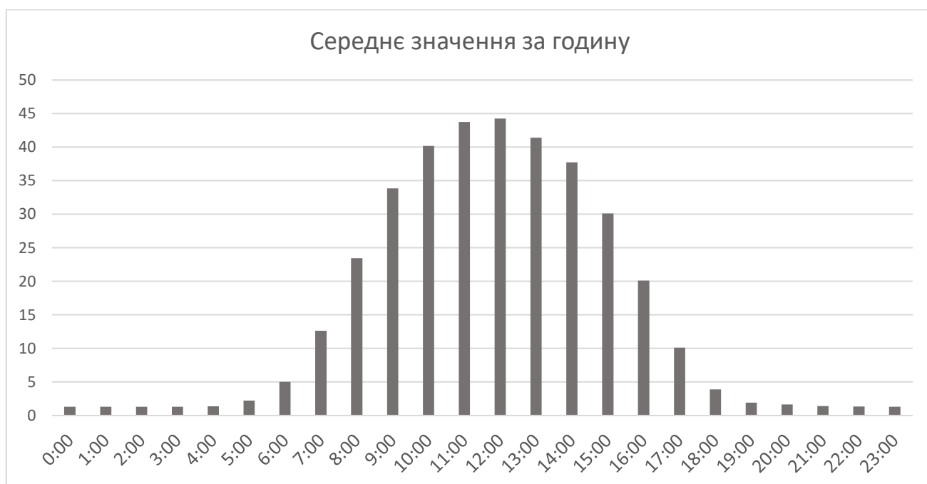
Рисунок 2.8 – Графік залежності усередненого значення генерації електричної енергії на СЕС по відповідним годинам доби.
