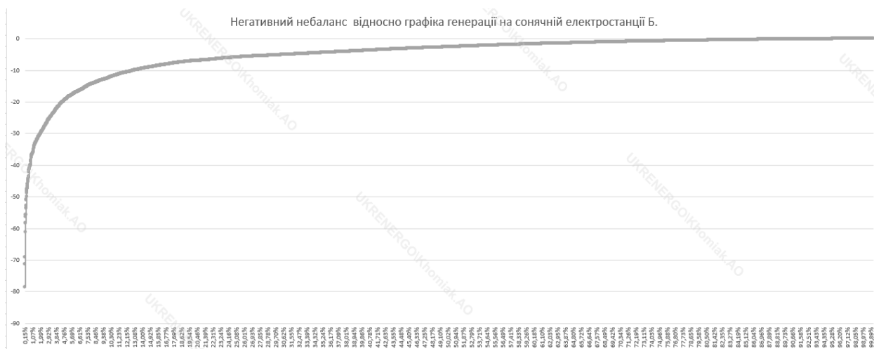
Рисунок 2.7 – Негативний небаланс електричної енергії відносно графіка генерації на сонячній електростанції Б.
