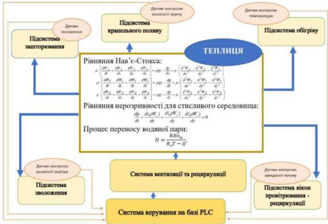
Рис.2.2. Структура мехатронної системи з моделлю теплиці
