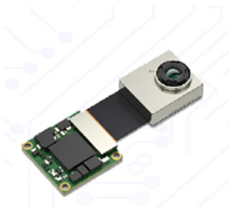
Рисунок 1.8 – Камера MINI212 Uncooled Miniature 256×192 VOx Thermal Module
