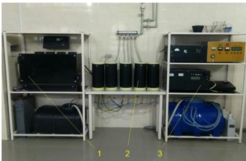
Рис. 2.1 Загальний вигляд експериментальної установки для отримання колоїдних розчинів біогенних нанометалів: 1 – електроіскровий генератор розрядних імпульсів; 2 – розрядні камери; 3 – блок керування електрофізичними параметрами технологічного процесу
