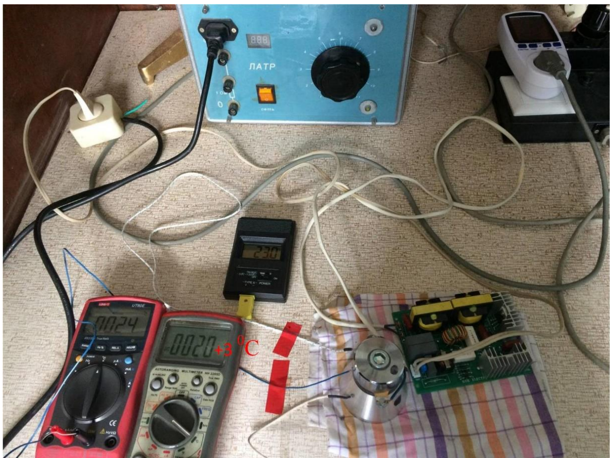
Рис. 5.22. Експериментальний стенд дослідження температури розігріву приладу
