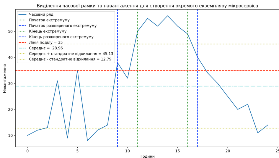
Рисунок 3.9 — Виділення навантаження мікропроцесора, яке слід запустити на іншому сервері. Стосовно моноліта — виділення часу його додаткового запуску
