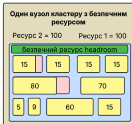
Рисунок 4.3 — Кількість безпечного ресурсу на звичайному вузлі залежно від його ключового критерію та пріоритетності запущених задач за звичайних умов лежить в межах 15–50%.
