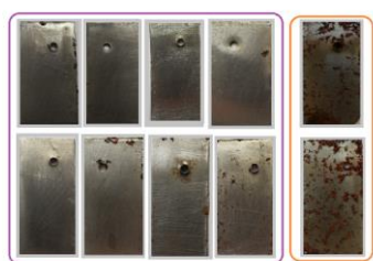
Рисунок 4.1 – Результати випробування ЛІАК при підвищених значеннях постійної вологості повітря (95%) і температури без конденсації вологи.
