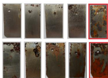
Рисунок 4.1 – Результати випробування ЛІАК при підвищених значеннях постійної вологості повітря (95%) і температури без конденсації вологи.
