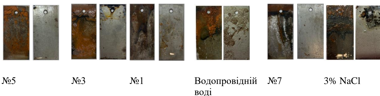
Рисунок 5.2 – Фото зразків після корозійних випробувань у водопровідній воді та модельних водно-сольових розчинах (288 годин, 1 мл/л, T=25 °C).
