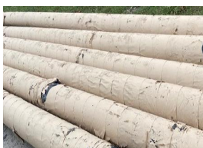
Рисунок 7.8 – Апробація тимчасового протикорозійного захисту прокату (інгібований папір) ТОВ «ПКФ «СТАНКОГИДРОСЕРВИС».
