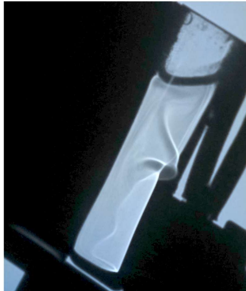
Рисунок 3.9 – Формування теплового пограничного шару. Кут нахилу 60^\circ (4 стадія)
