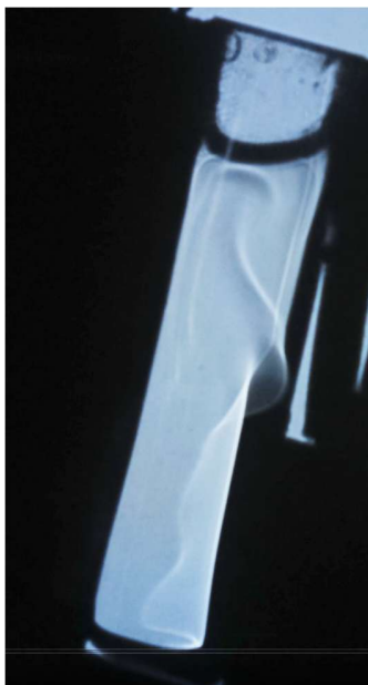
Рисунок 3.8 – Формування теплового пограничного шару. Кут нахилу 75^\circ (4 стадія)
