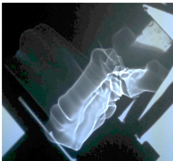
Рисунок 3.12 – Пізні стадії формування пограничного шару.
