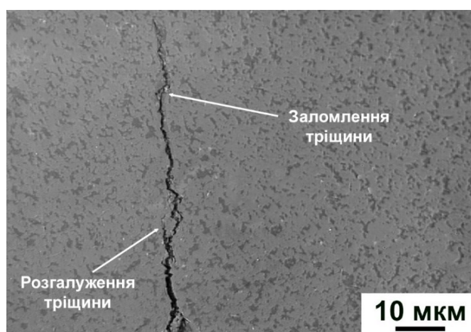
Рисунок 4.17 – Оптичний знімок тріщини Палмквіста, що поширилась з одного з кутів відбитку від індентора на полірованій поверхні твердого сплаву WC-15Co, який піддавали ХІП
