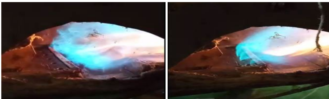
Рисунок 5.2 Вигляд факелу при спалюванні чистого пропан-бутану та його суміші з домішками водню.
