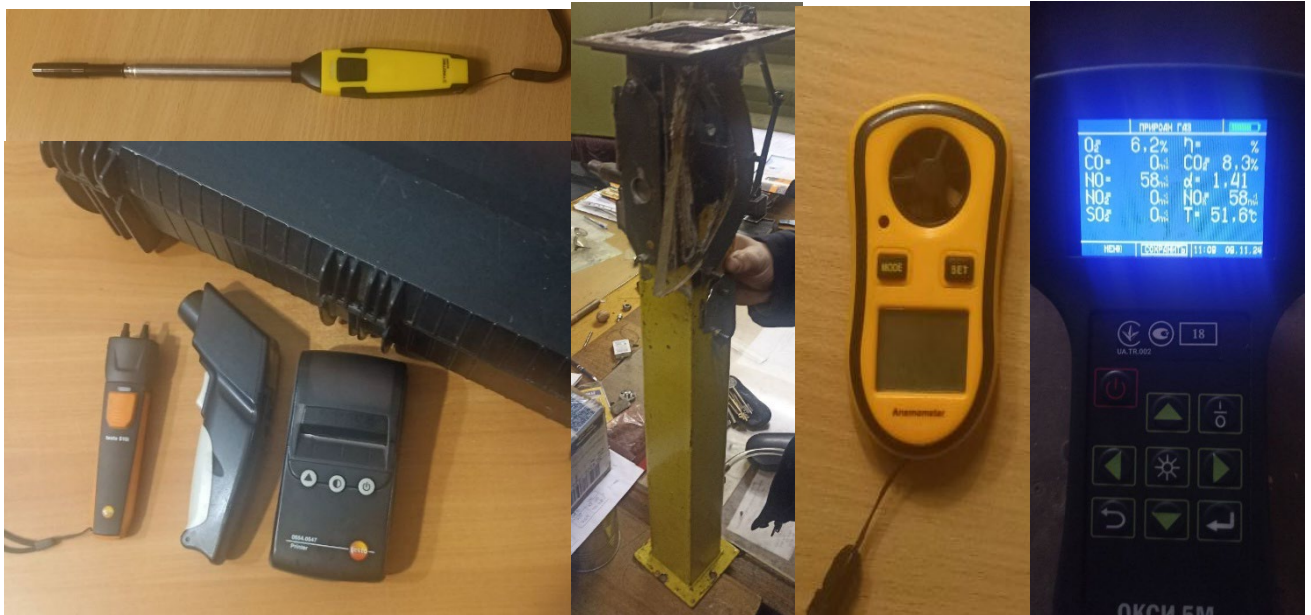
Рис. 2.4 - Аеродинамічний стенд з вимірювальною апаратурою
