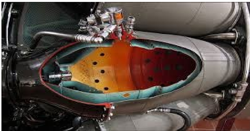
Рисунок 1.10. Камера згорання.
