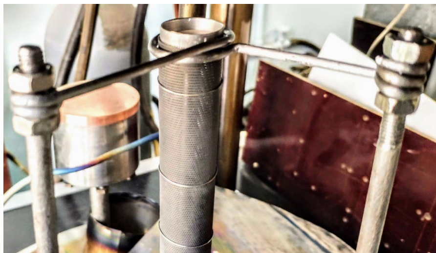
Рисунок 4.4 Кріплення верхньої частини електродної системи в зборі
