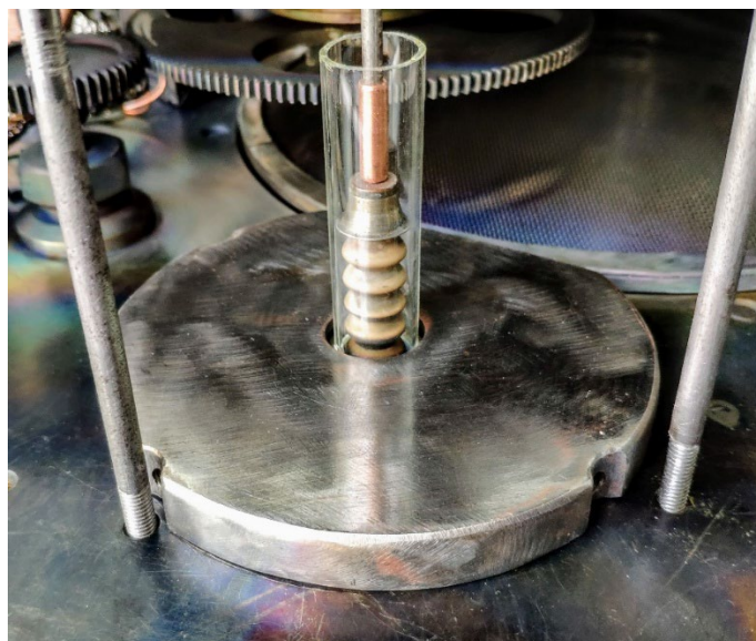
Рисунок 4.2 Анод з системою ізоляторів
