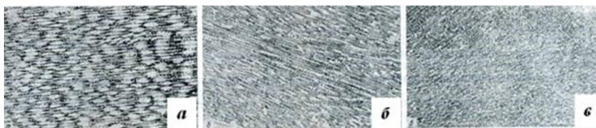
Рисунок 1.7 – Зміна дендритів структури наплавленого металу в залежності від режиму зварювання ( \times 100 , зменш. 1/2) [42]: а – без модуляції, б, в – з модуляцією
