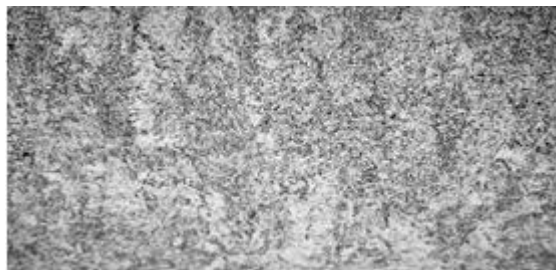
Рисунок 5.5 – Характерна мікроструктура зразку ( \times 200 ), що наплавлений за режимом I_n = 125,0 А, V_n = 0,0072 м/с, A = 0,006 м, \nu = 2,5 Гц
