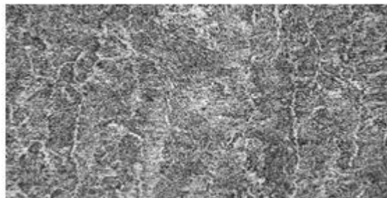
Рисунок 5.11 – Характерна мікроструктура зразку ( \times 200 ), що наплавлений за режимом I_n = 200,0 А, V_n = 0,0072 м/с без впливу коливань
