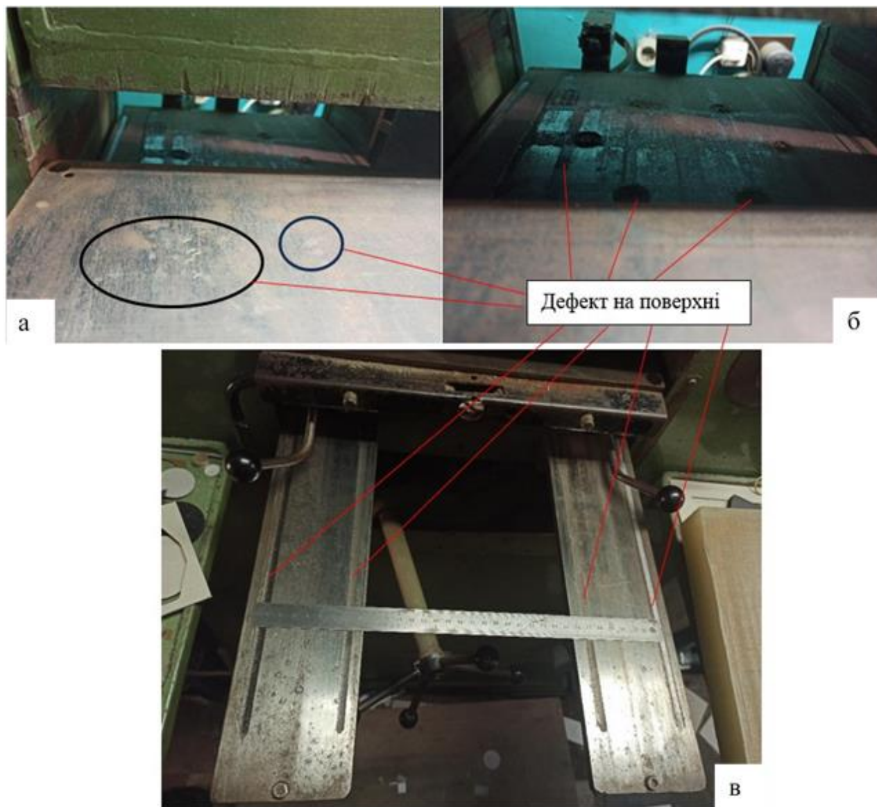
Рис. 5.14 – Загальний вигляд дефектів на поверхні пластин: а – верхньої, б – нижньої, в – на направляючих
