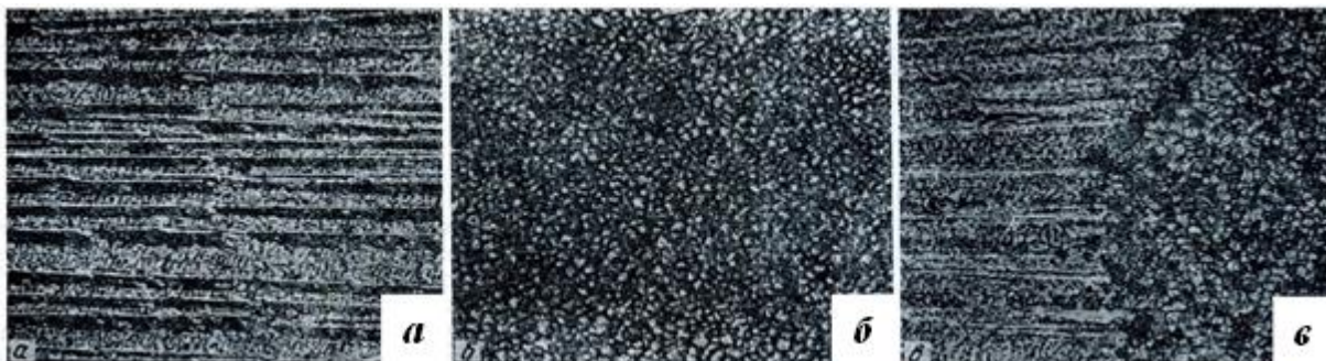
Рисунок 1.6 – Структура металу в горизонтальному перетині зварного шва ( \times 125 , зменш. 2/3): а – без імпульсного підігріву, б – з локальним імпульсним підігрівом з частотою 7,0 Гц, в – момент включення імпульсного підігріву [20]
