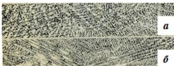
Рисунок 1.4 – Мікроструктура поздовжнього перерізу металу шва сплаву ВЖ98 ( \times 100 ): а – з накладенням імпульсів струму, б – без накладення імпульсів струму [41]
