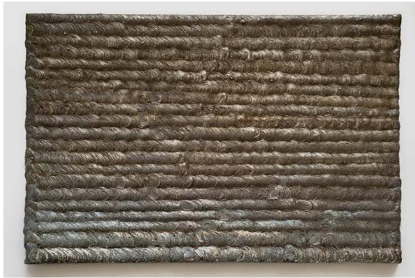
Рис. 5.16 – Загальний вигляд опорної плити після наплавлення та зварювання
