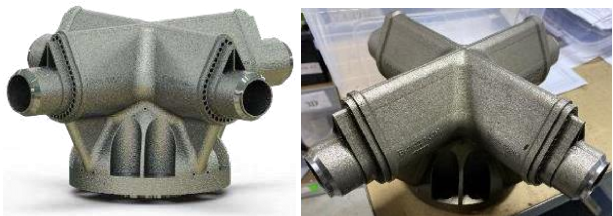
Рисунок 4.14 – Конструкція центральної частини газопідводу
