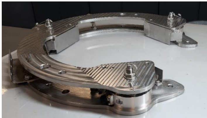
Рисунок 3.23 – Загальний вигляд тяговимірювального пристрою
