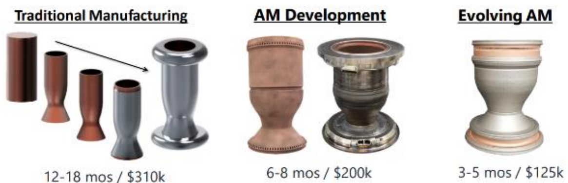
Рисунок 1.10 – Порівняння використання адитивного виробництва з традиційними підходами [23]
