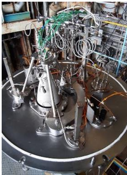
Рисунок 3.22 – Загальний вигляд робочого місця для випробування двигуна малої тяги
