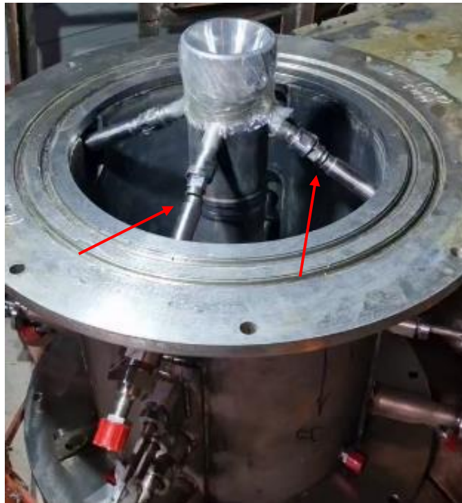
Рисунок 5.6 – Загальний вигляд пошкодженої газо-ежекторної установки після випробувань
