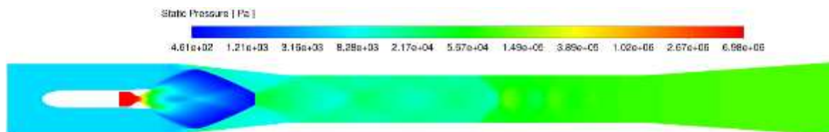
Рисунок 2.11 – Розподіл статичного тиску у проточній частині стенду (логарифмічна шкала) поблизу ГЕУ
