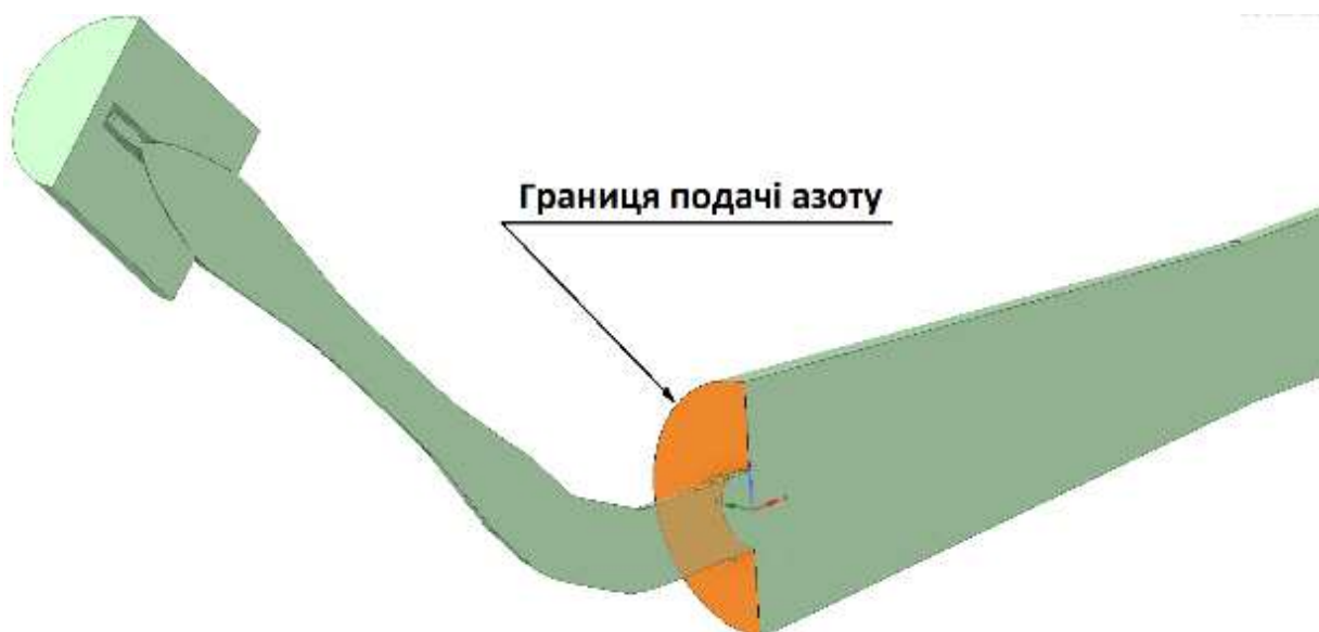
Рисунок 2.8 – Поверхня ГДТ1, що використовується для подачі азоту
