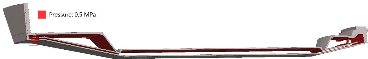
Рисунок 3.11 – Схема навантаження моделі ГДТ20
