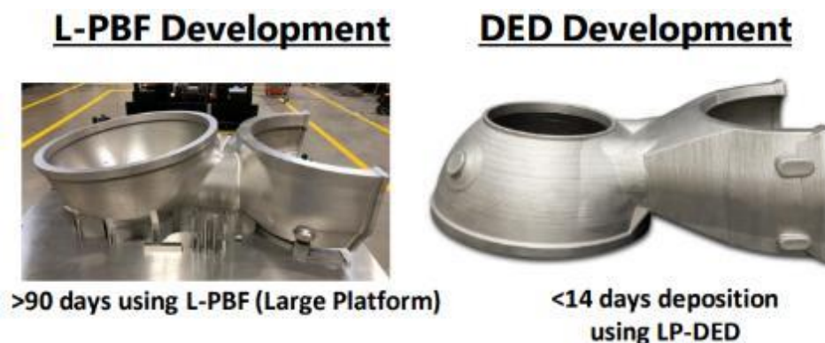
Рисунок 1.11 – Порівняння використання технології L-PBF та DED виробництва [23]
