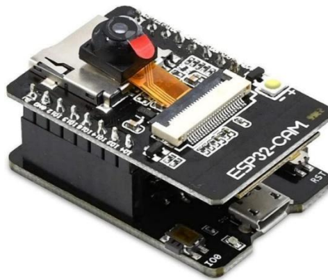
Рисунок 13 – Зовнішній вигляд модулю ESP32-CAM з камерою та платою USB інтерфейсу
