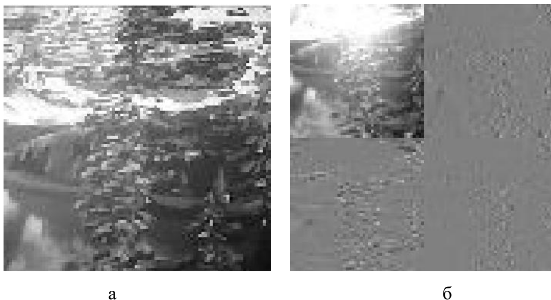
Рисунок 22 – Досліджувані зображення: а) – оригінальне зображення з камери модулю ESP32-CAM, б) – зображення після використання перетворення Хаара
